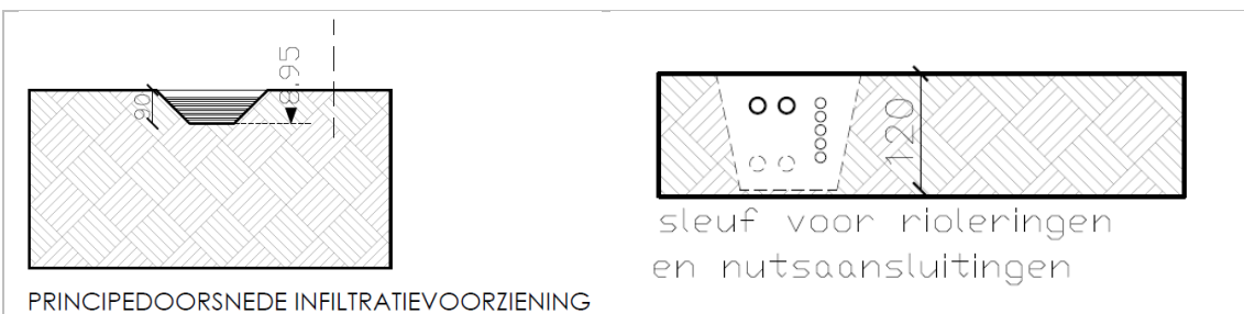
Figuur 10: Principedoorsnede infiltratievoorziening (ARCHITECTENBUREAU TYBERGHIE & PARTNERS BVovvCVBA, 2017)
