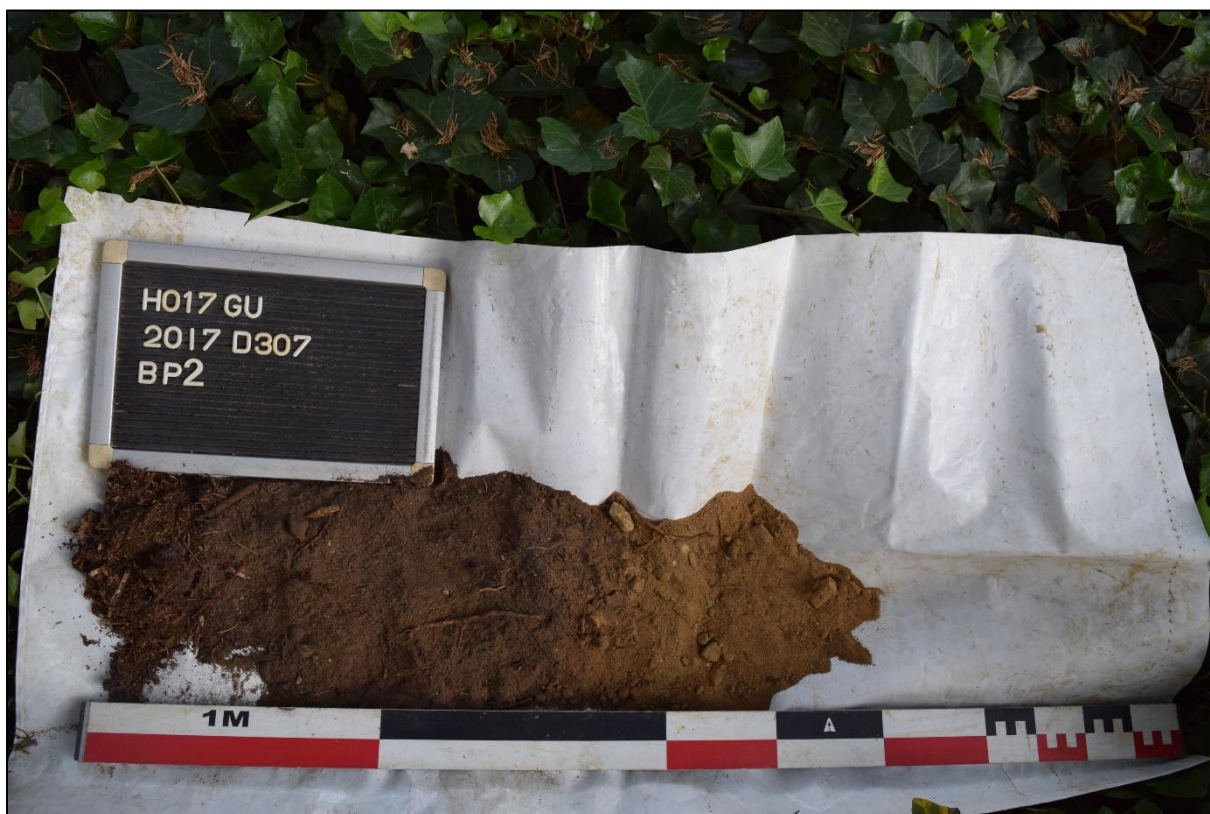
Afb. 26: Boorpunt BP 2 met horizonten Ah – Ap – C (Aron bvba, 12/06/2017, 2017D307)
