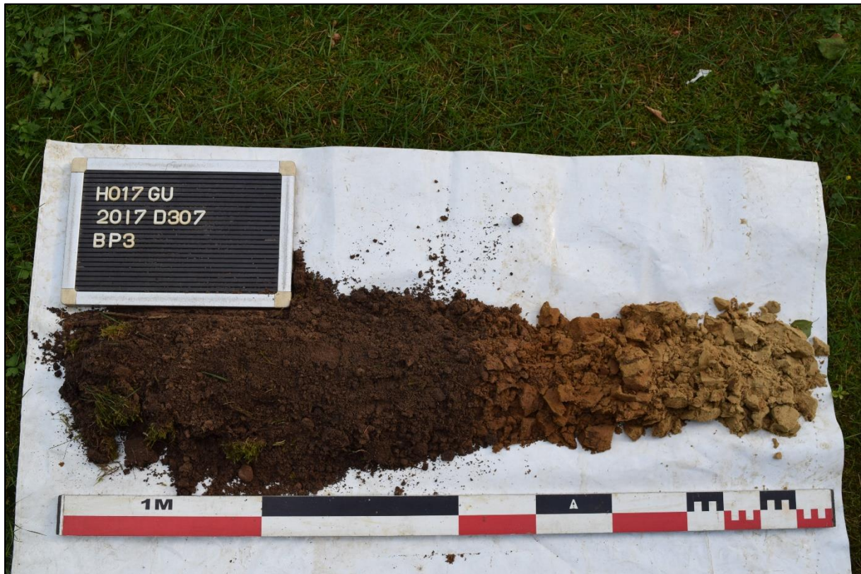
Afb. 27: Boorpunt BP 3 met horizonten Ap – Bs – Cg (Aron bvba, 12/06/2017, 2017D307)
