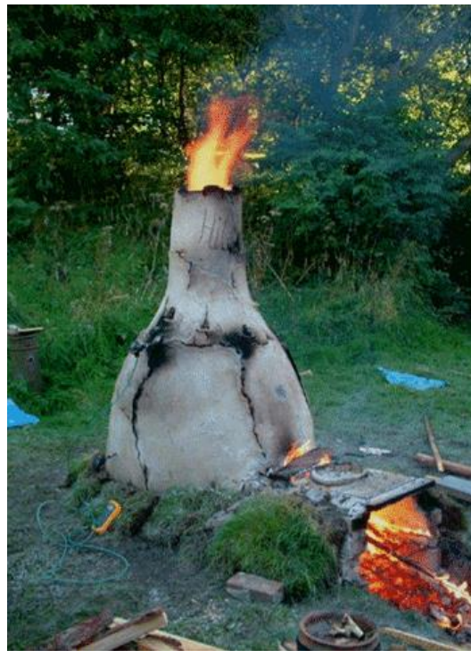
Figuur 33. Traditionele oven voor de productie van ijzer, aardewerk etc. ( www.makers.org.uk/pottery/ffglasgow ).
