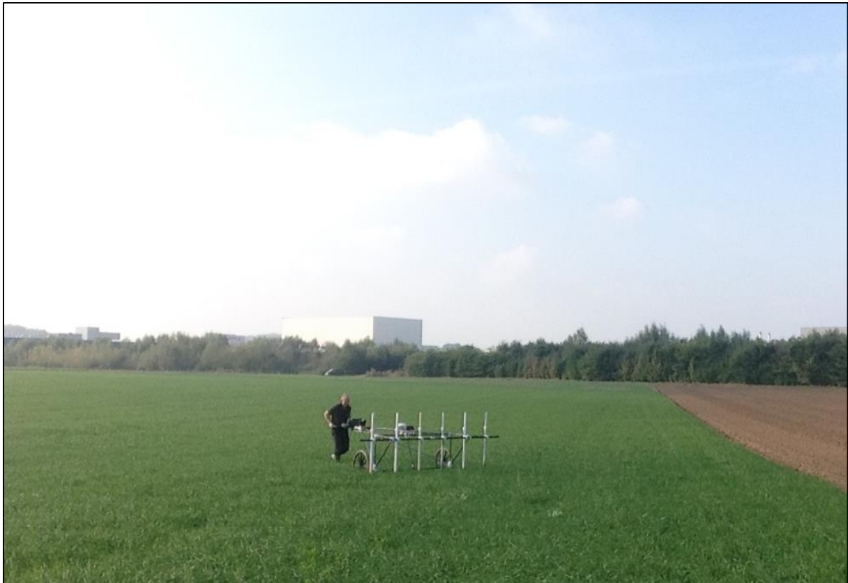
Afb. 10: Geofysisch onderzoek met een Grad601-wagensysteem (Bron: Aron bvba, dd. 20/12/2016).
