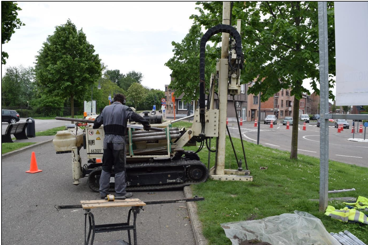
Afb 28. : De voor het onderzoek gebruikte mechanische Geoprobe boorstelling op rupsbanden, Geonius bv (foto ARON bvba)
