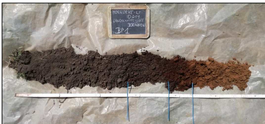
Foto 1 Uitgelegd boorprofiel BP1
