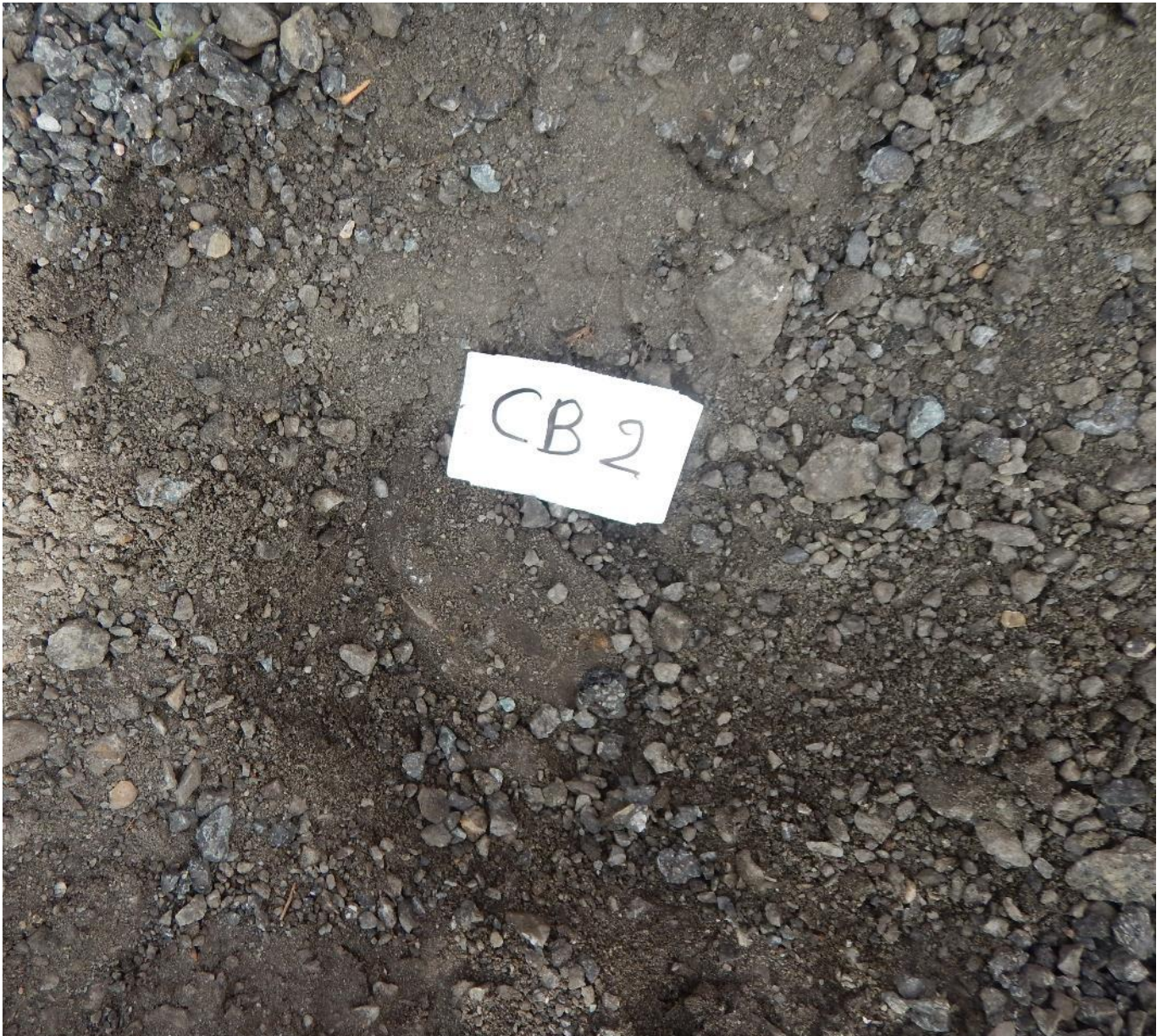
Figuur 25: Foto controleboring CB2, put is 15 cm diep met op de bodem een grote steen.
