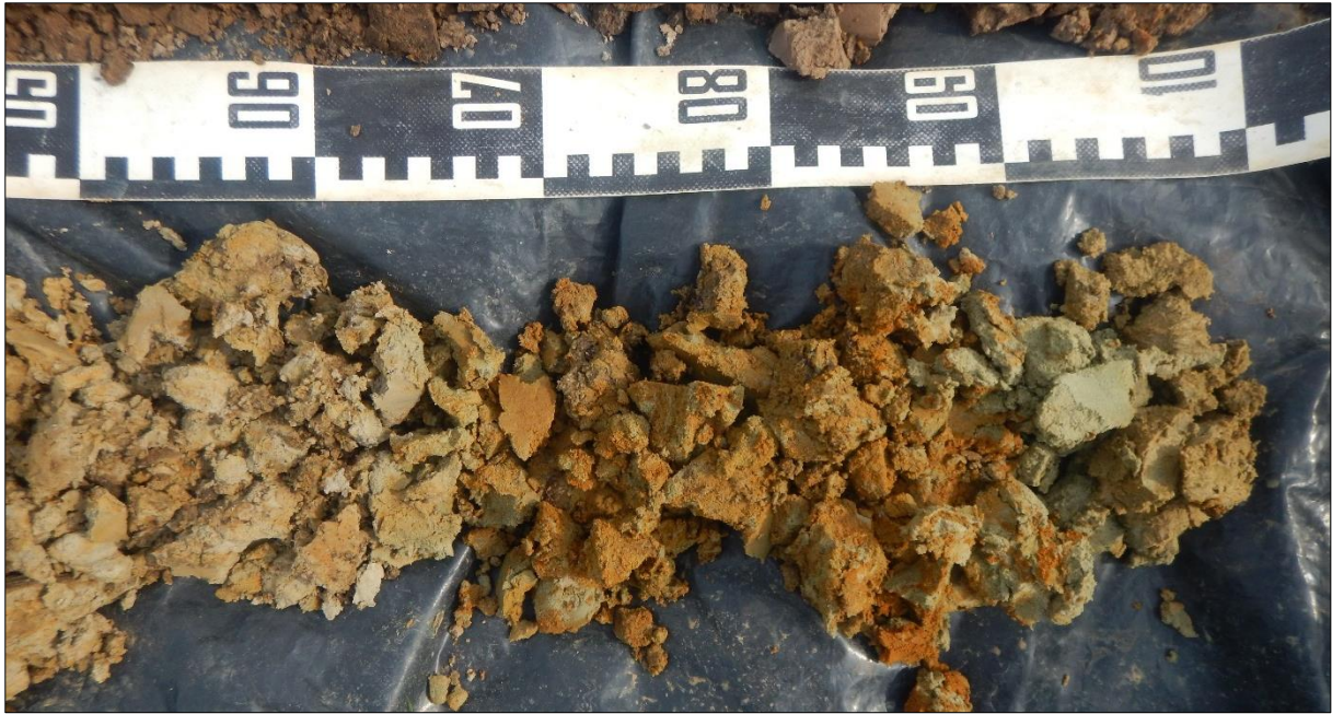
Foto 18: Boring 2 - detail: 2Cg-3Cr-4Cg-sequentie 165-200 cm (©BAAC)
