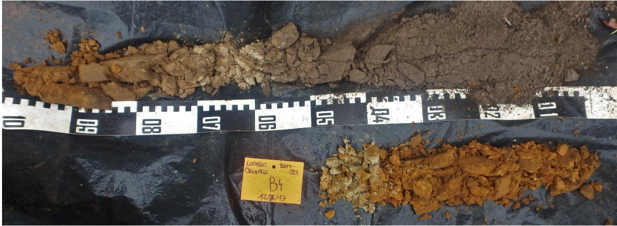
Figuur 49: Boring 4, van 0 (rechtsboven) tot 150 cm (rechtsonder) beneden maaiveld.
