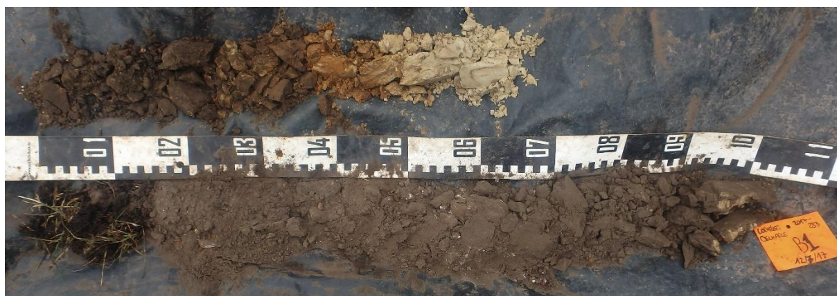
Figuur 46: Boring 1, van 0 (linksonder) tot 175 cm (rechtsboven) beneden maaiveld.
