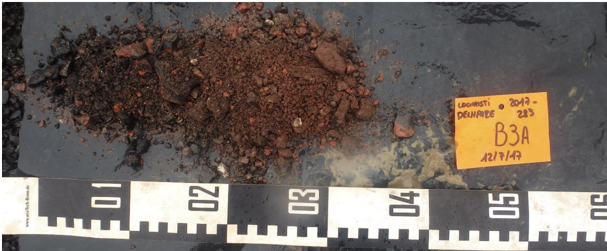
Figuur 47: Boring 3A, van 0 (linksboven) tot 30 cm beneden maaiveld.
