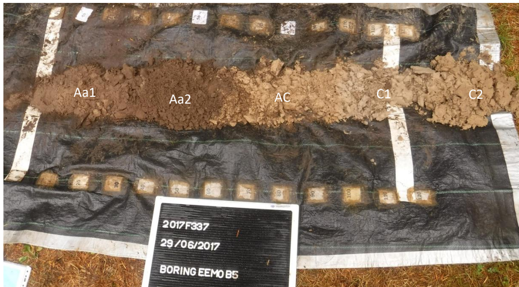
Figuur 28: Bodemprofiel van boring EEMO B5; met aanduiding van de aangetroffen horizonten.
