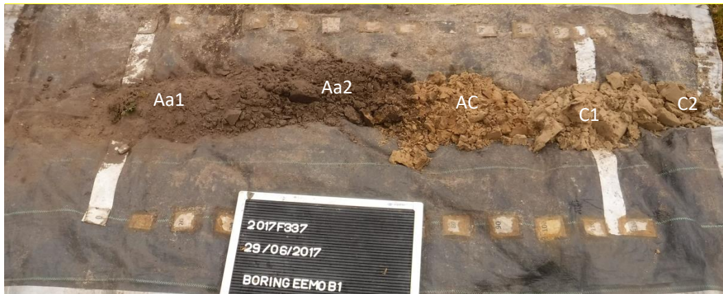
Figuur 24: Bodemprofiel van boring EEMO B1, met aanduiding van de aangetroffen horizonten.
