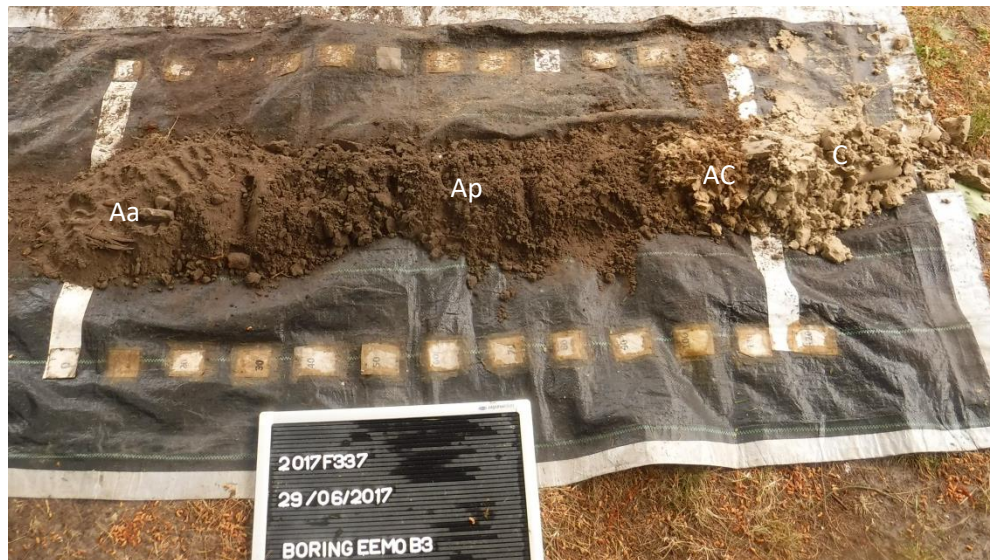
Figuur 26: Bodemprofiel van EEMO B3, met aanduiding van de aangetroffen horizonten.
