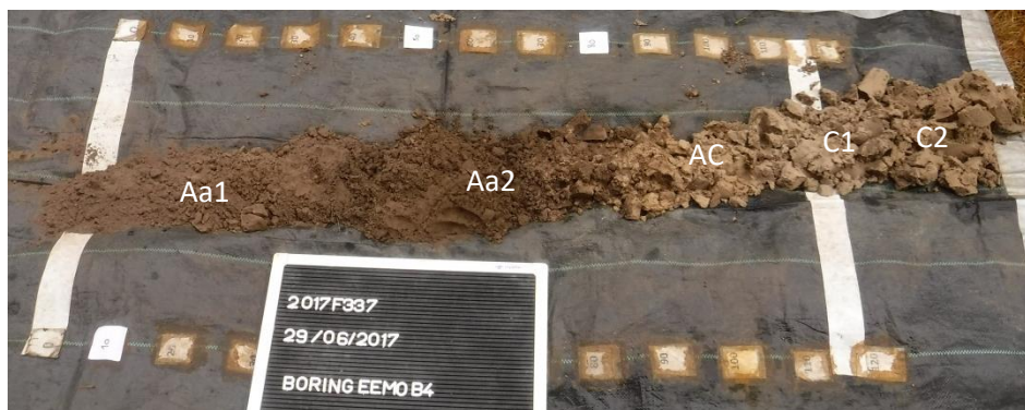
Figuur 27: Bodemprofiel van EEMO B4, met aanduiding van de aangetroffen horizonten.
