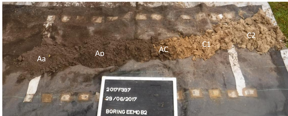
Figuur 25: Bodemprofiel van EEMO B2, met aanduiding van de aangetroffen horizonten.
