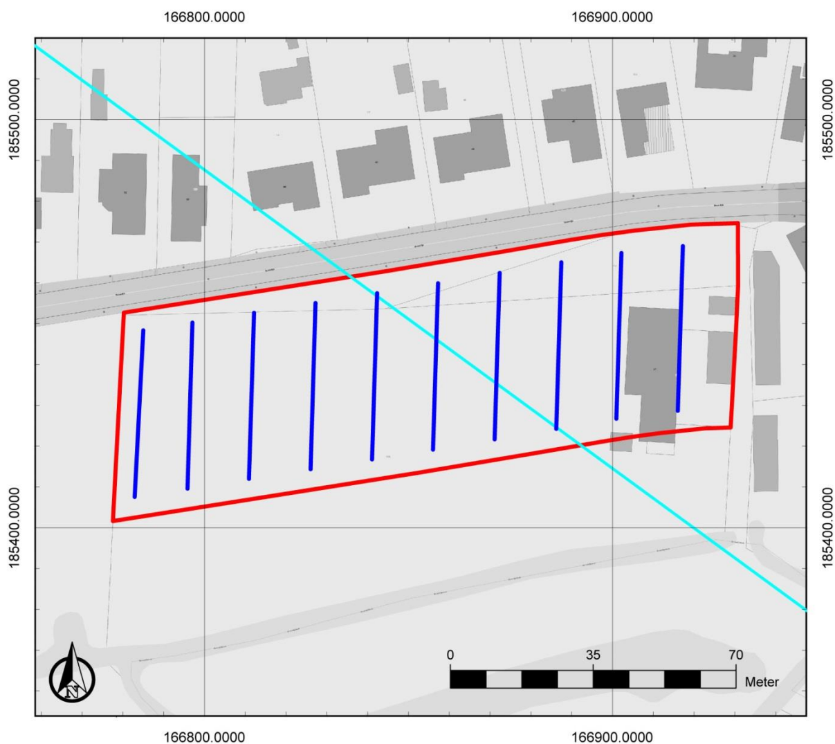
Figuur 5: Inplanting van de proefsleuven (blauw) en de verwachte KW-linie (lichtblauw)
