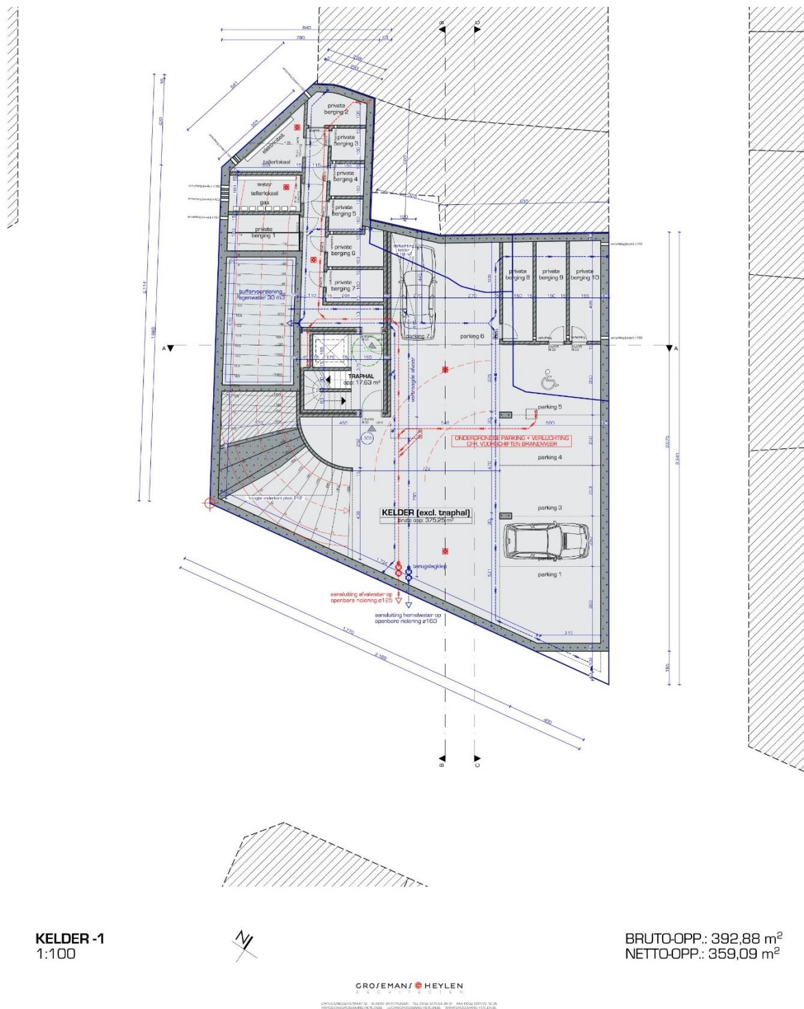
Afbeelding 4: de inplanting van de kelder, Grosemans-Heylen architecten
