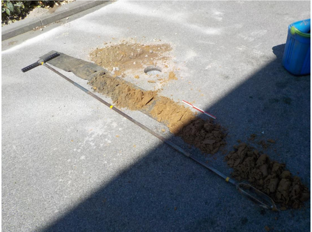
Afb. 36. Boring 1, een asfaltboring. Uitleg van links naar recht: 0- 100 cm –mv, 100-150 cm –mv, 150- 200 cm –mv (05-07-2017).
