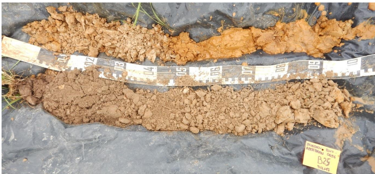
Figuur 35: Boring 25 van 0 (linksonder) naar 200 cm (rechtsboven) onder het maaiveld. Het AC-horizont is te zien tussen 30 en 45 cm beneden het maaiveld. (©BAAC)
