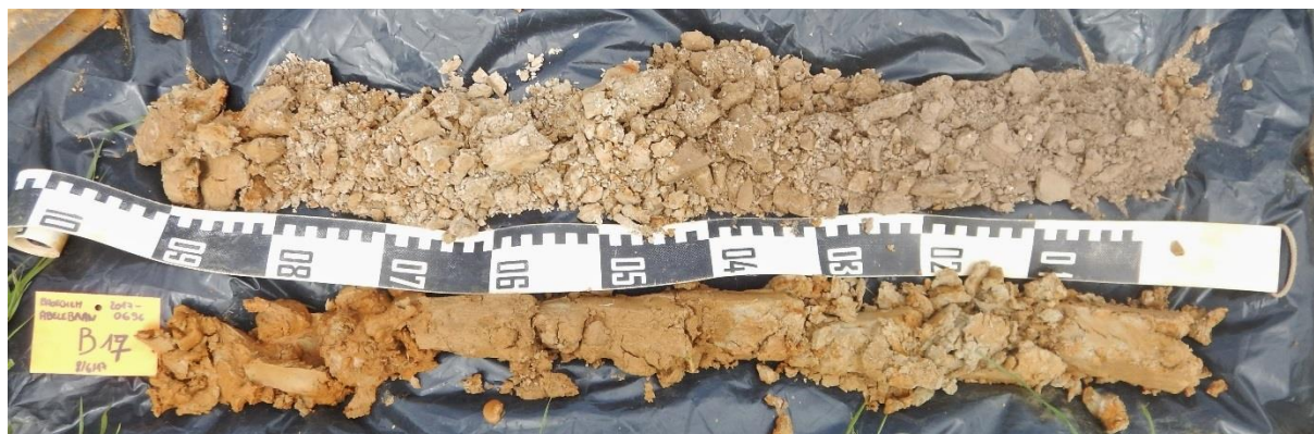
Figuur 37: Boring 17 van 0 (rechtsboven) naar 200 cm (linksonder) onder het maaiveld. De zandige klei is te zien vanaf 40 cm diepte, terwijl vanaf 80 cm diepte kleig zand werd gezien. (©BAAC)
