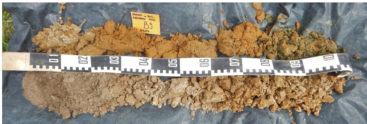
Figuur 39: Boring 9 van 0 (linksonder) naar 200 cm (rechtsboven) onder het maaiveld. Het eolisch leemmateriaal is te zien tot 120 cm diepte, gevolgd door eolische dekzand. Het tertiair bodemmateriaal is gezien vanaf 180 cm diepte. (©BAAC)
