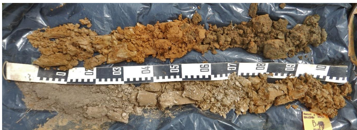
Figuur 40: Boring 19 van 0 (linksonder) naar 200 cm (rechtsboven) onder het maaiveld. Het eolisch leemmateriaal reikte tot 70 cm beneden het maaiveld. Tot 120 cm diepte zag men een fluviatiel zandig kleipakket. Eolische dekzand nam men waar vanaf 130 cm diepte. Het donkergroen Tertiair bodemmateriaal is gezien vanaf 160 cm diepte. (©BAAC)
