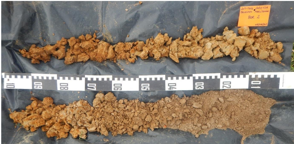
Figuur 33: Boring 2 van 0 (rechtsonder) naar 200 cm (linksboven) onder het maaiveld. Het AC-horizont is te zien tussen 40 en 50 cm beneden het maaiveld. (©BAAC)
