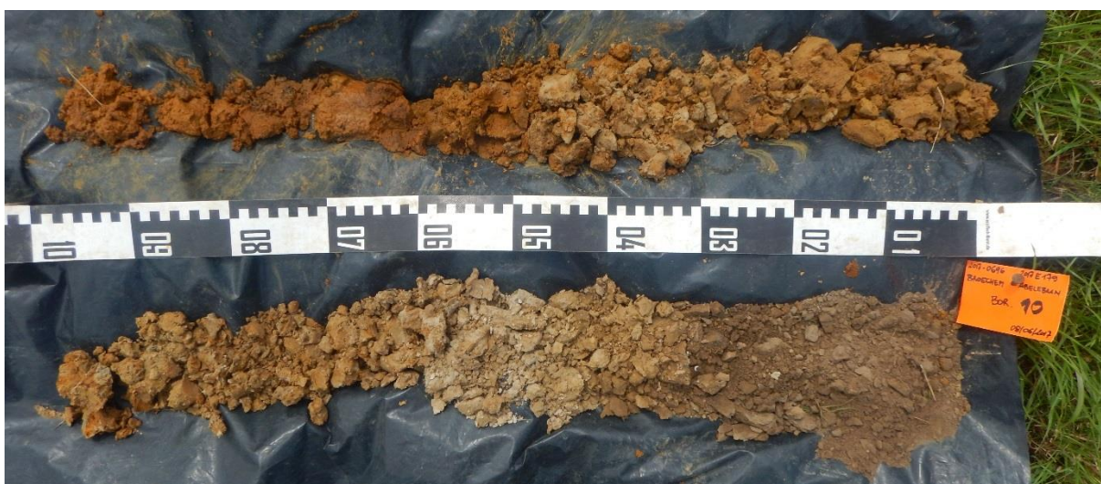
Figuur 36: Boring 10 van 0 (rechtsonder) naar 200 cm (linksboven) onder het maaiveld. Het oranje dekzand is te zien vanaf 150 cm diepte. (©BAAC)
