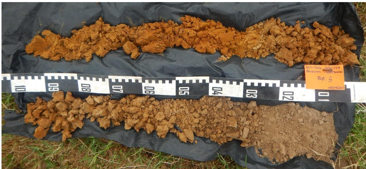
Figuur 34: Boring 3 van 0 (rechtsonder) naar 200 cm (linksboven) onder het maaiveld. Het AC-horizont is te zien tussen 25 en 43 cm beneden het maaiveld. (©BAAC)
