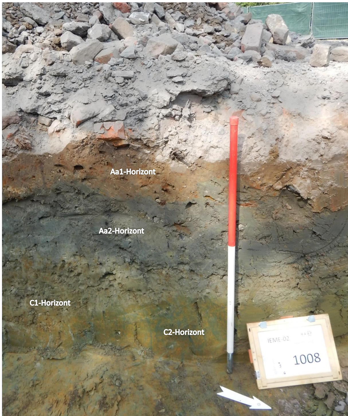
Figuur 10: Profiel 6 (in het noorden van het plangebied) met de gebruikelijke bodemopbouw binnen het plangebied waarbij zich hier op de overgang tussen de Aa2 Horizont en de C horizont een grindpakket bevindt (C1 horizont ).
