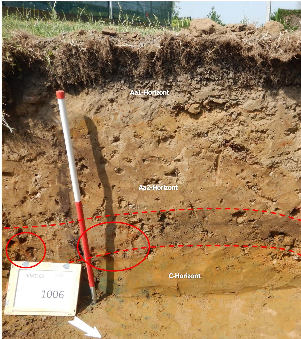
Figuur 11: Profiel 5. In dit deel van het plangebied is de bodem niet gereduceerd en heeft de Ap2 horizont een donkerbruine tot bruine kleur. Aan de onderzijde van de laag tekent zich een donkerbruine band af (rode stippellijn) waarin munitie en schrapnelfragmenten werden aangetroffen (rode cirkels).
