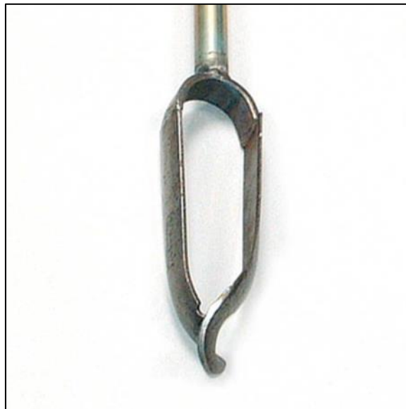
Figuur 24: Combiboor met een diameter van 7 cm en gutsboor met een diameter van 3 cm (Bron: http://www.eijkelpark.com )
