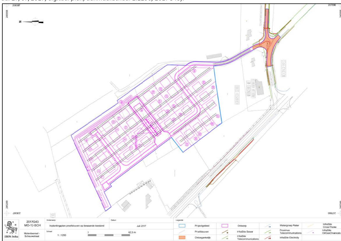
Afb. 26: Sleuvenplan op ontworpen toestand met aanduiding van het onderzoeksgebied (blauw) en de nutsleidingen (Aron bvba, dd. 27/07/2017, digitaal plan, aanmaatschaal 1.1250, 2017G43).
