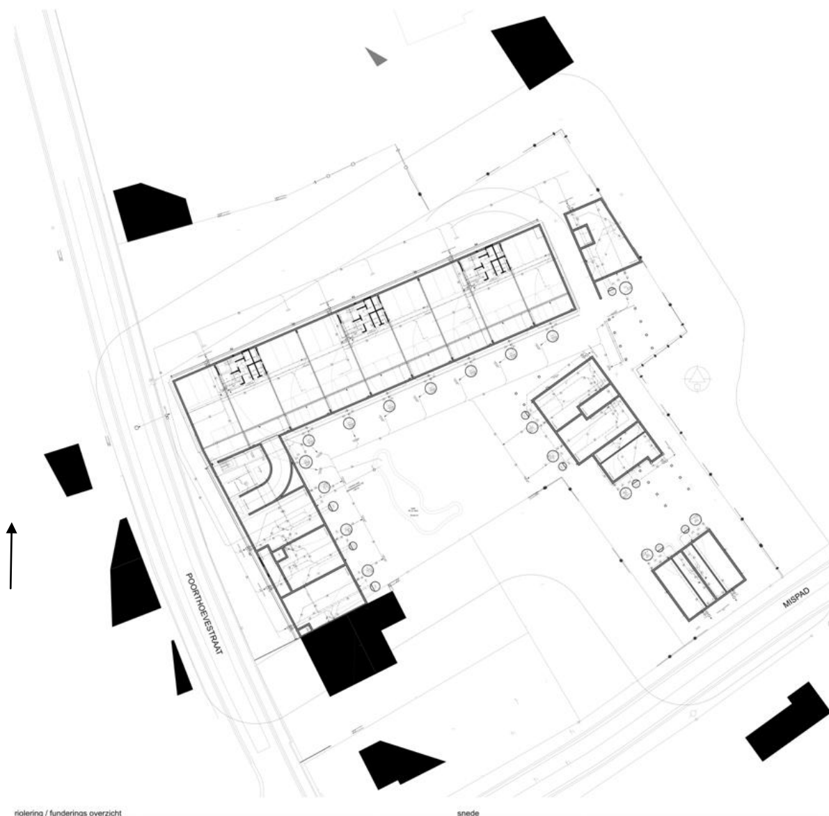
Afb. 28. Overzicht van de fundering en de riolering
