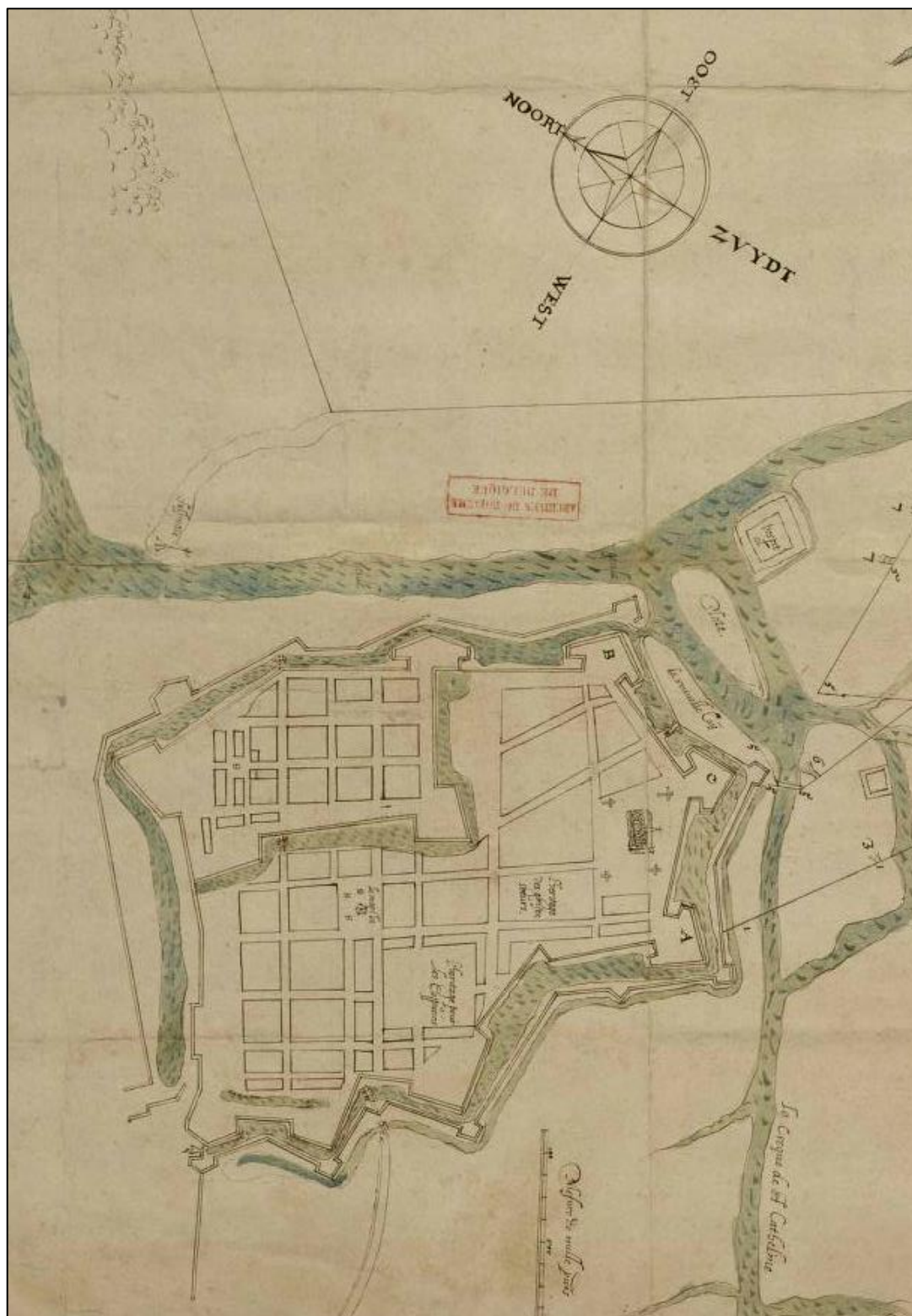
Figuur 23: Plan van de stad Oostende en van een dijk door de Geul, voorgesteld door ingenieur de Cauwerven (ca.1730) 80
