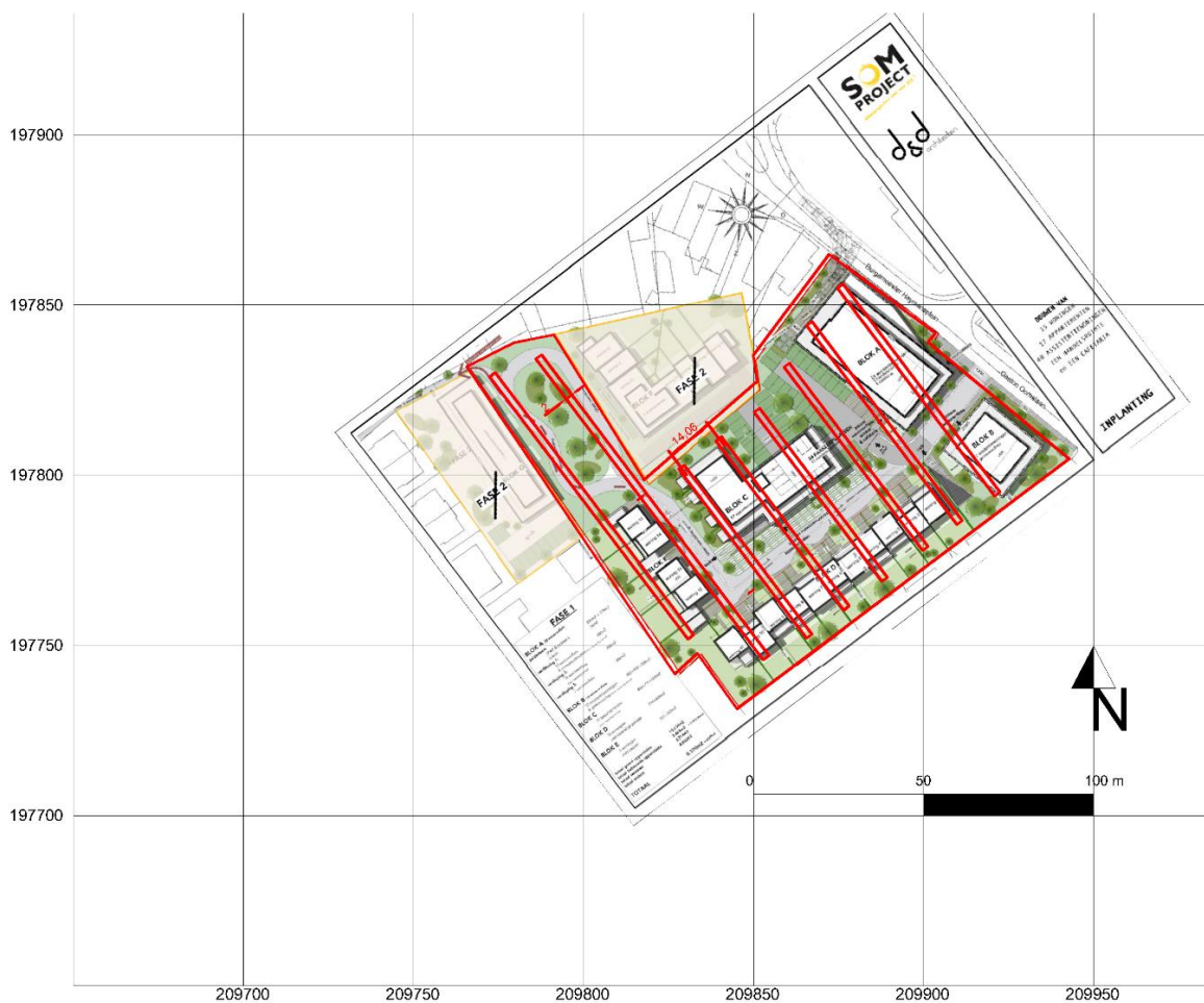
Afbeelding 13: projectie op de inplanting van het voorstel van de proefsleuven
