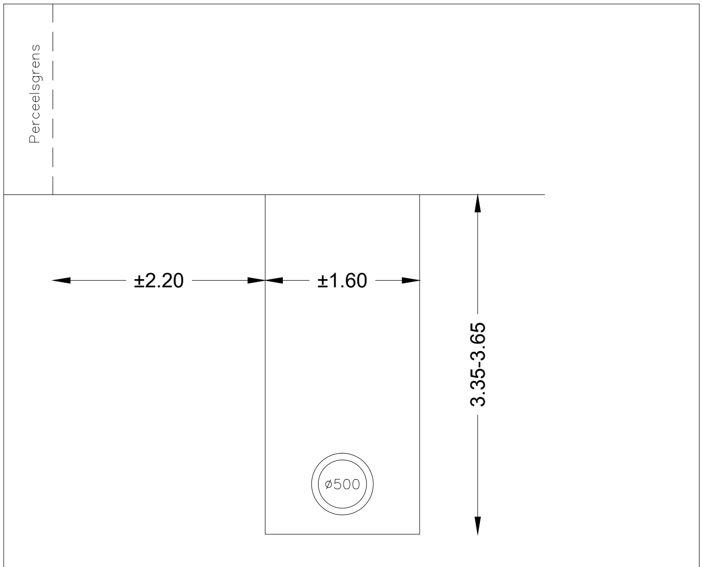
Figuur 7: modeldwarsprofiel voor de aanleg van de riolering, behorend bij figuur 6 (© ASSET nv)
