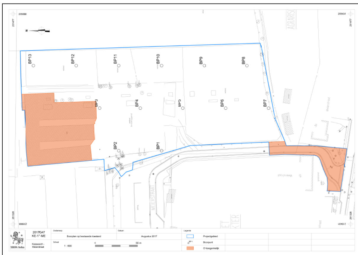
Afb. 30: Boorplan met aanduiding van de boorpunten en het onderzoeksterrein (blauw) op bestaande toestand (BT) (ARON bvba, digitaal plan, dd. 25/08/2017, aanmaatschaal 1.600, 2017G47).
