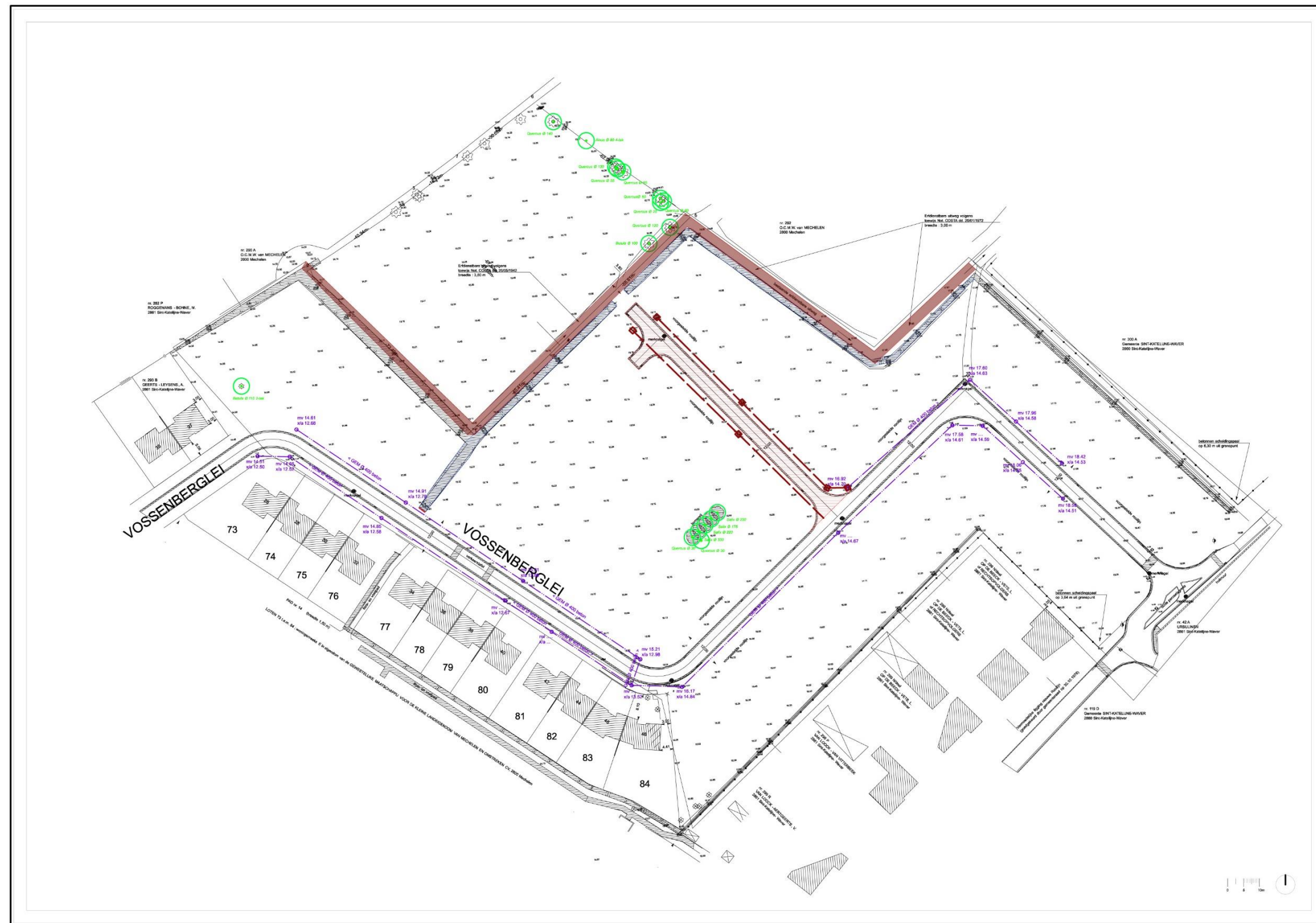
Figuur 3: Bestaande toestand met aanduiding van te kappen bomen, op te breken verharding en riolering, af te breken muur en te dempen afwateringsgracht (LAND b.v.b.a., in opdracht van de Vlaamse Maatschappij voor Sociaal Wonen (VMSW))
