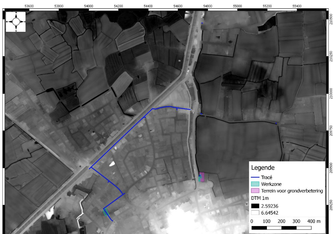
Figuur 18: Overzichtskaart en detail van het DTM (1m) met aanduiding van het tracé (blauw), de werkzones (groen) en het terrein voor grondverbetering (paars). Respectievelijk aangemaakt op schaal 1:25000 en 1:7500. (Bron: Geopunt 2017)
