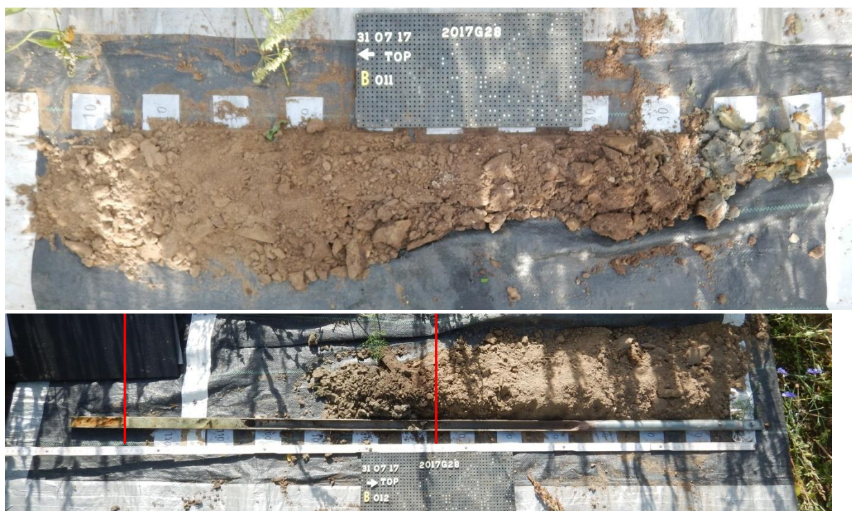
Figuur 27: Boorprofiel 11 en 12 met aanduiding van de restanten van de vijver
