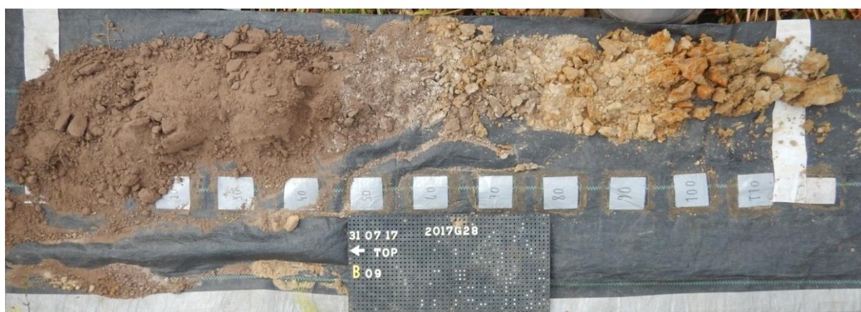
Figuur 28: Boorprofiel 9 met aanduiding van de kalkrijke laag onder de A-horizont
