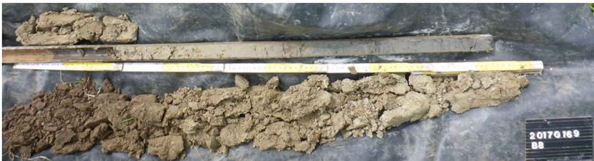
Figuur 48. Het opgeboord sediment van boring B8 met de typesequentie voor de projectzone.
