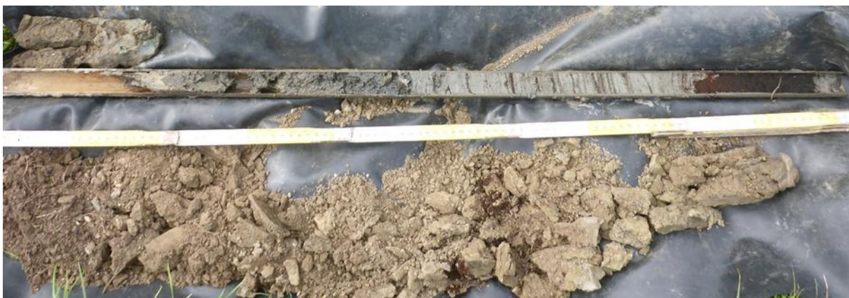
Figuur 49. Het opgeboord sediment van boring B7 met onderaan het venig niveau en de verstoorde bovengrond.
