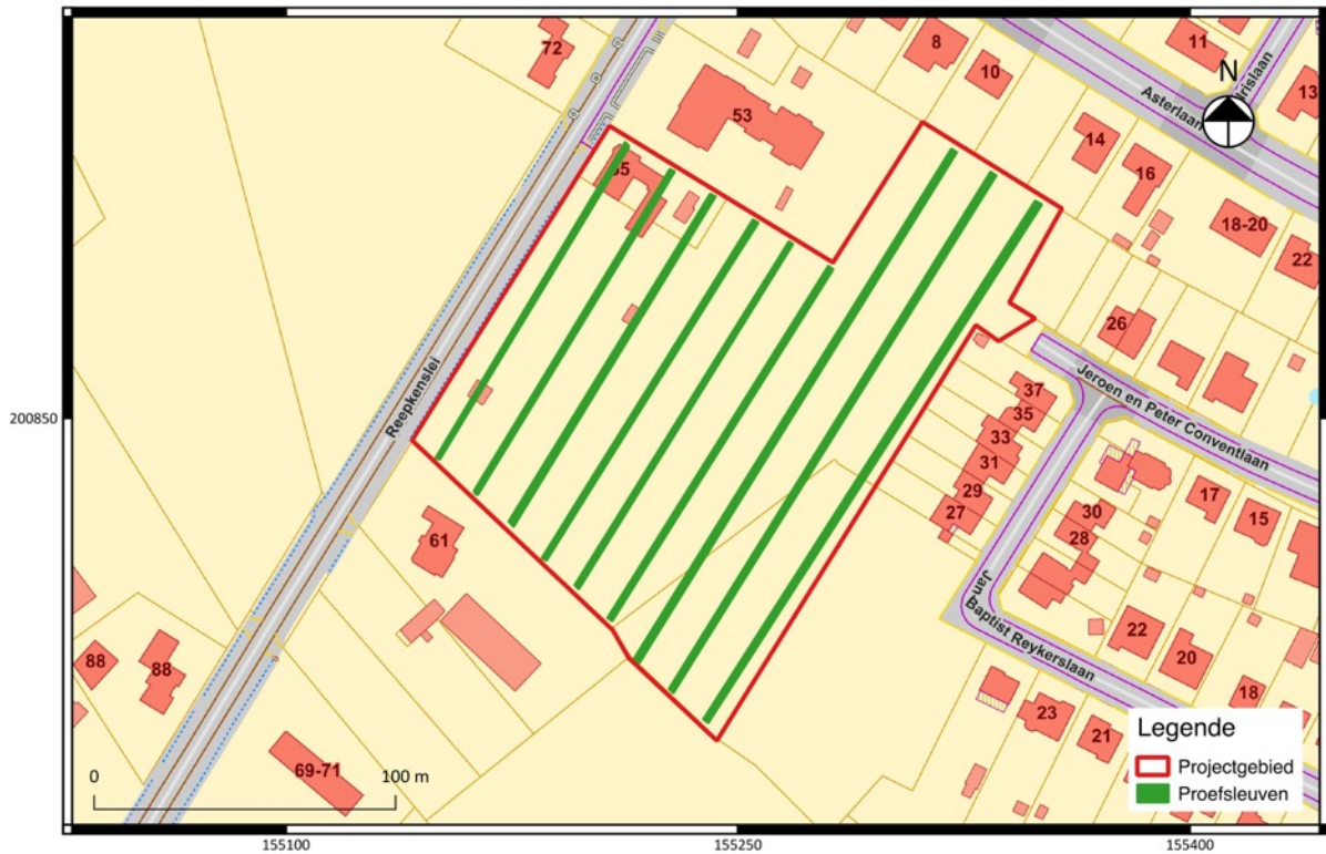
Fig. 2.3: Voorstel tot inplanting proefsleuven.
