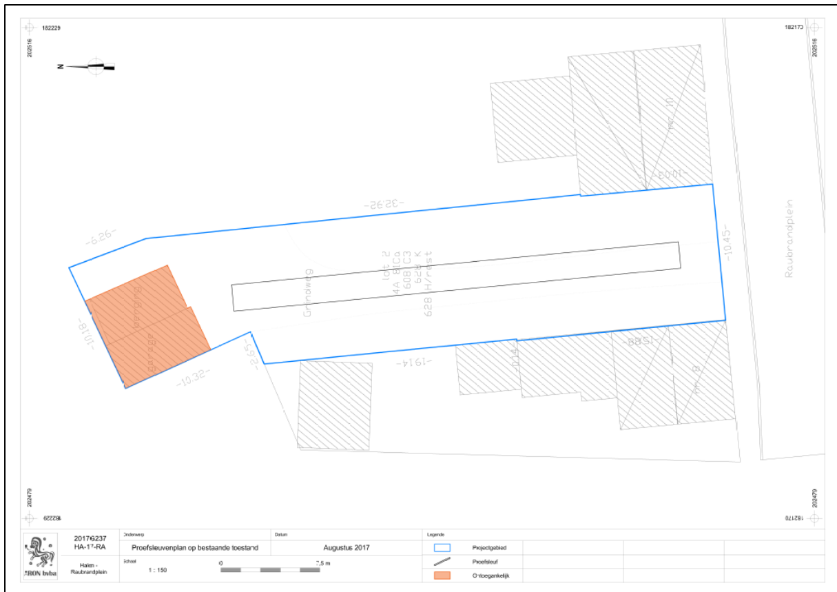
Afb. 31: Sleuvenplan op bestaande toestand met aanduiding van het onderzoeksgebied (blauw) en de te behouden garageboxen (bruin) (Aron bvba, dd. 25/08/2017, digitaal plan, aanmaatschaal 1.150, 2017G237).
