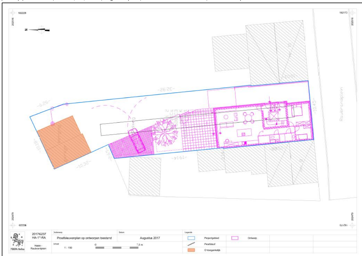
Afb. 32: Sleuvenplan op ontworpen toestand met aanduiding van het onderzoeksgebied (blauw) en de te behouden garageboxen (bruin) (Aron bvba, dd. 25/08/2017, digitaal plan, aanmaatschaal 1.150, 2017G237).
