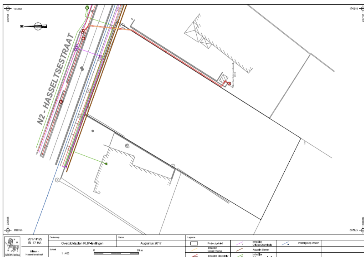
Afb. 24: Overzicht aanwezige nutsleidingen op het onderzoeksterrein (Bron: KLIP, digitaal plan, dd 11/08/2017, aanmaakschaal 1.400, 2017H122).
