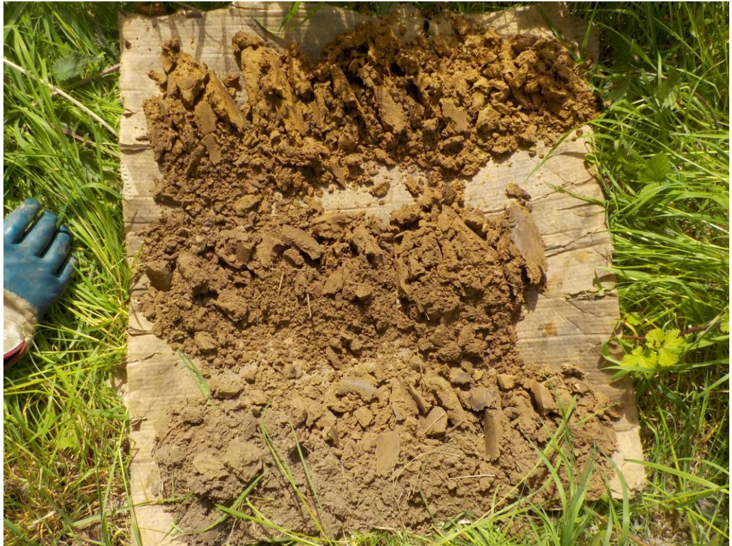
Afb. 42. Het ingegraven bodemprofiel van boring 5 (uitgelegd: 0-50 cm/50 – 100 cm/100-150cm).
