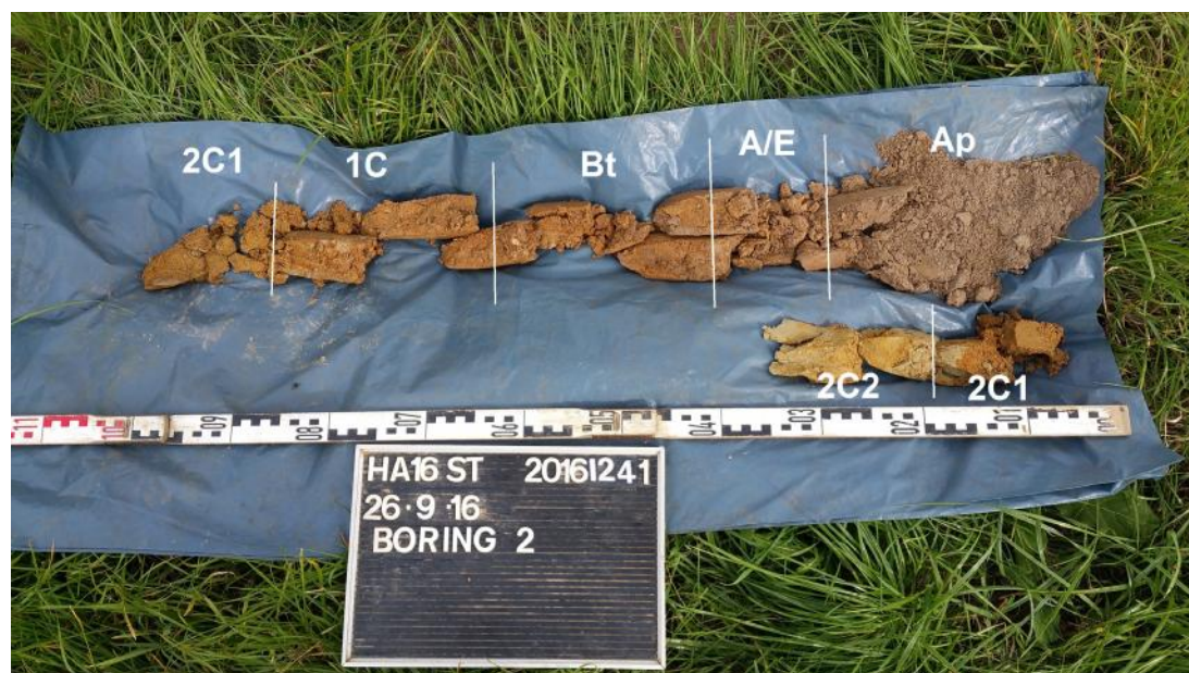
Afbeelding 20: Foto van boring 2 met aanduiding van de verschillende bodemhorizonten.
