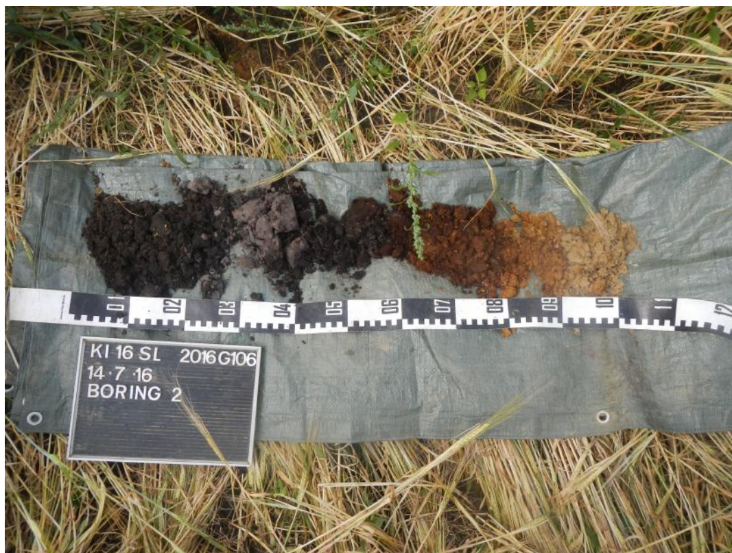
Afbeelding 21: Foto van boring 2. Op de foto kunnen duidelijk de verschillende bodemhorizonten herkend worden.
