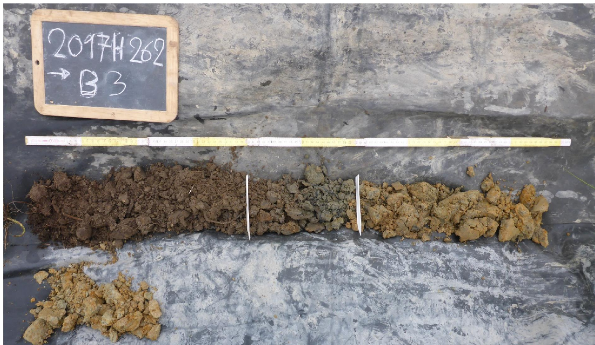
Figuur 22. Foto boring 3. Voorbeeld AC- profiel
