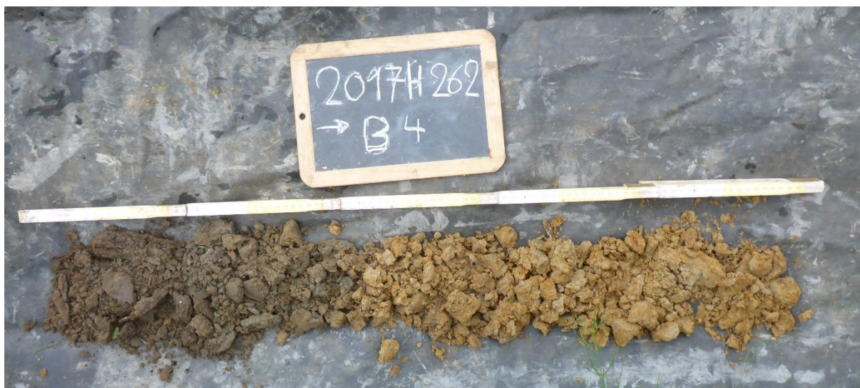
Figuur 23. Foto boring 4 Voorbeeld AC- profiel
