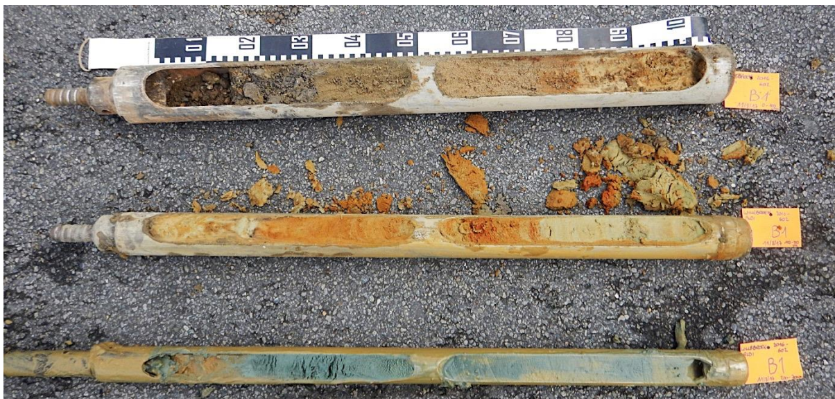
Foto 8: Boring 1, van 0 (linksboven) tot 300 cm (rechtsonder) beneden het maaiveld. (©BAAC)
