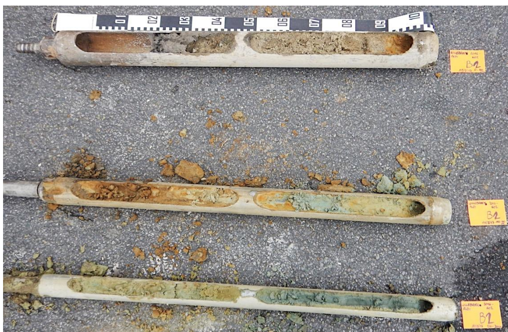
Foto 9: Boring 2, van 0 (linksboven) tot 300 cm (rechtsonder) beneden het maaiveld. (©BAAC)
