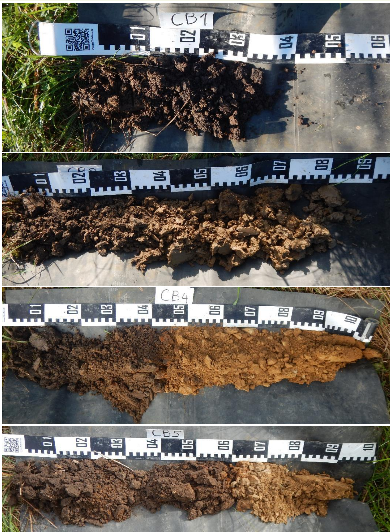
Figuur 24: Boorstaten controleboringen
