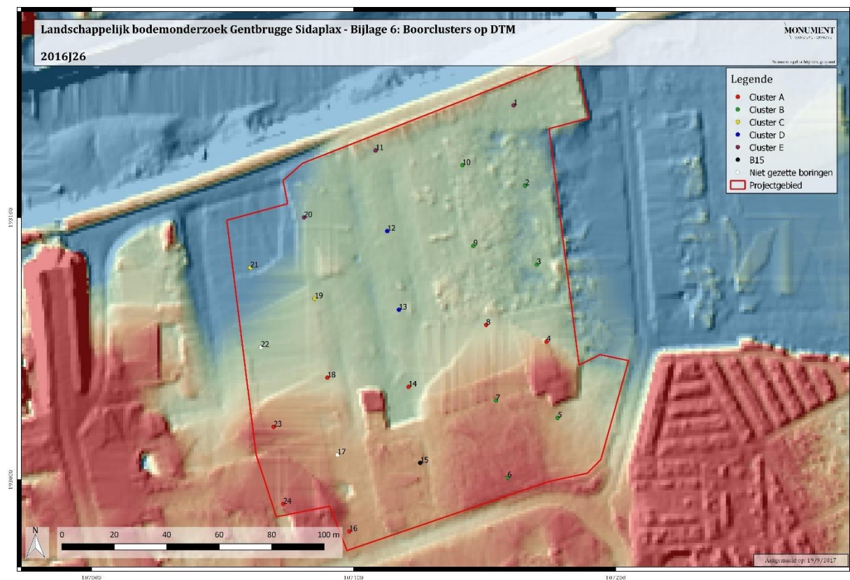
Figuur 7: Hoogtekaart afgeleid van het digitale terreinmodel met aanduiding van de boorclusters.
