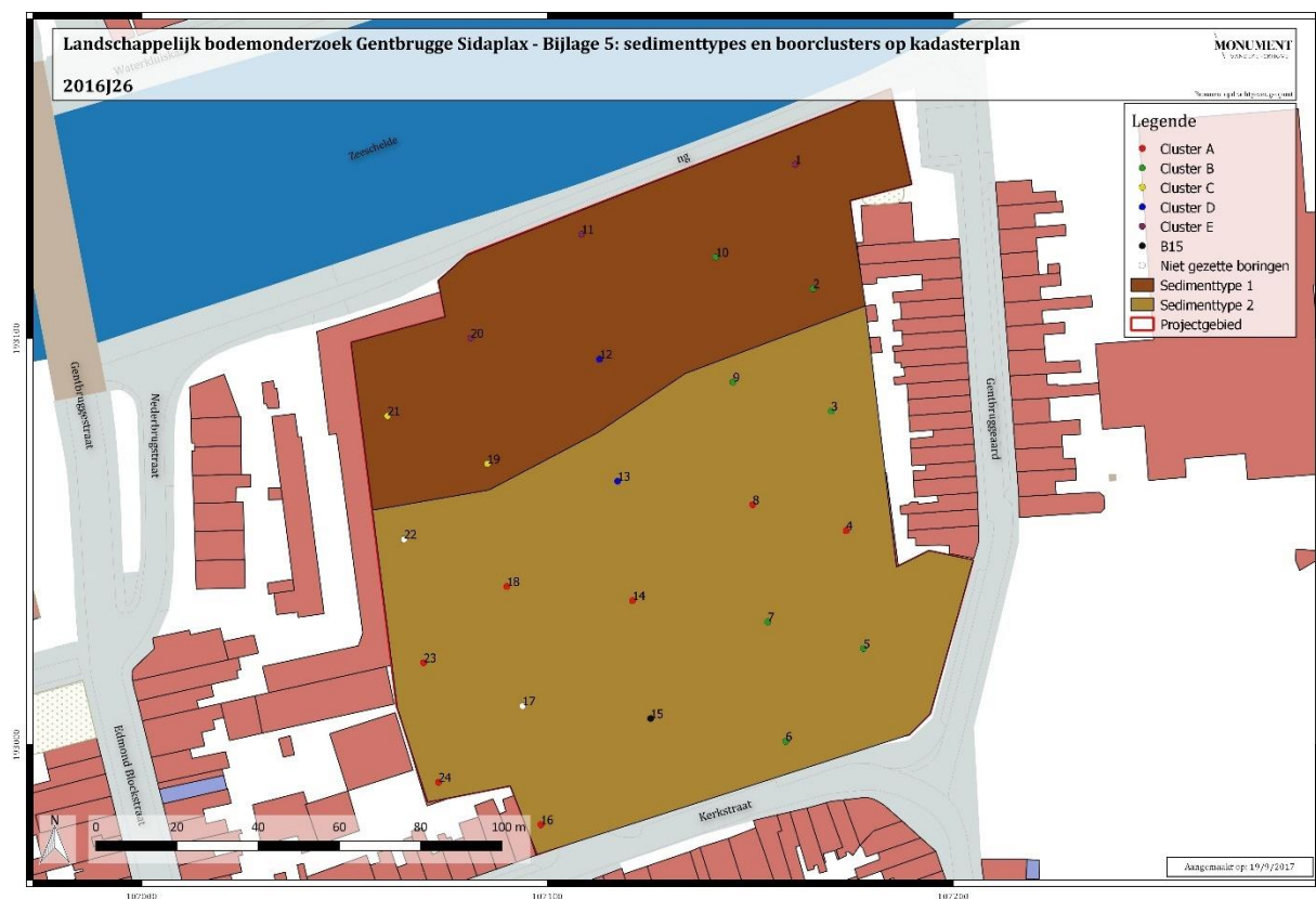
Figuur 5: Aanduiding van de twee verschillende sedimenttypen binnen het projectgebied, zoals waargenomen in de boringen. Sedimenttype 1 omvat het licht bruinig tot gelig grijze lemig zand. Sedimenttype 2 bevat naast lemig zand ook een kleiig interval.
