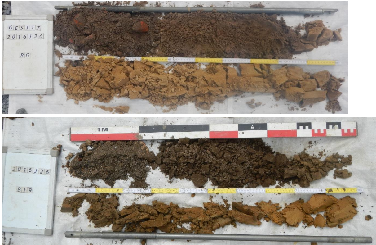
Figuur 4: Boven: Foto van boring 6 (B6) met het donkergrijze moedermateriaal onder de donkerbruine teelaardelaag. Dit is een voorbeeld van sedimenttype 1. Onder: Foto van boring 19 (B19) met het gelige tot bruinig grijze moedermateriaal met vanaf 130cm diepte een 40cm dik kleig interval.
