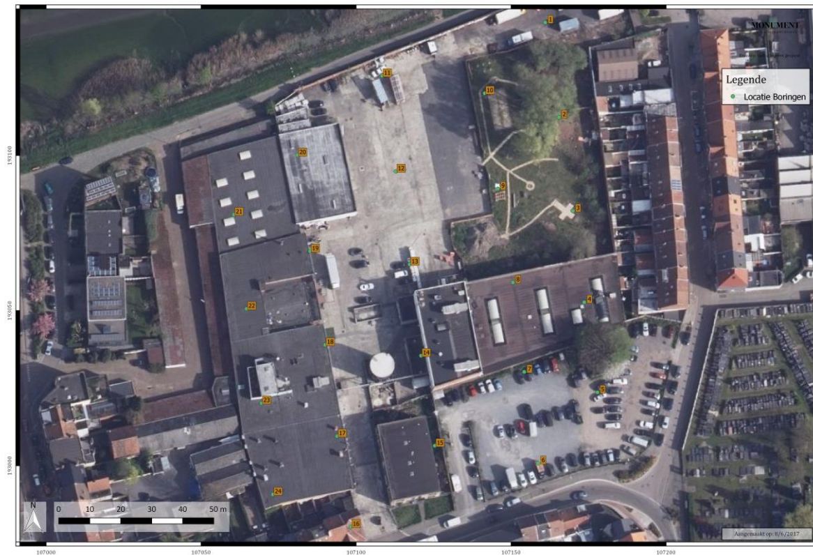
Figuur 1: Projectgebied met situering van de boringen in het projectgebied op een orthofoto. De 24 boringen zijn verdeeld in 5 boorreeksen dwars op de Schelde en vormen een gelijkbenig driehoeksgrid met een tussenafstand van ca. 30m. Zie ook bijlage 4. De exacte coördinaten van de boringen zijn te vinden in bijlage 1.
