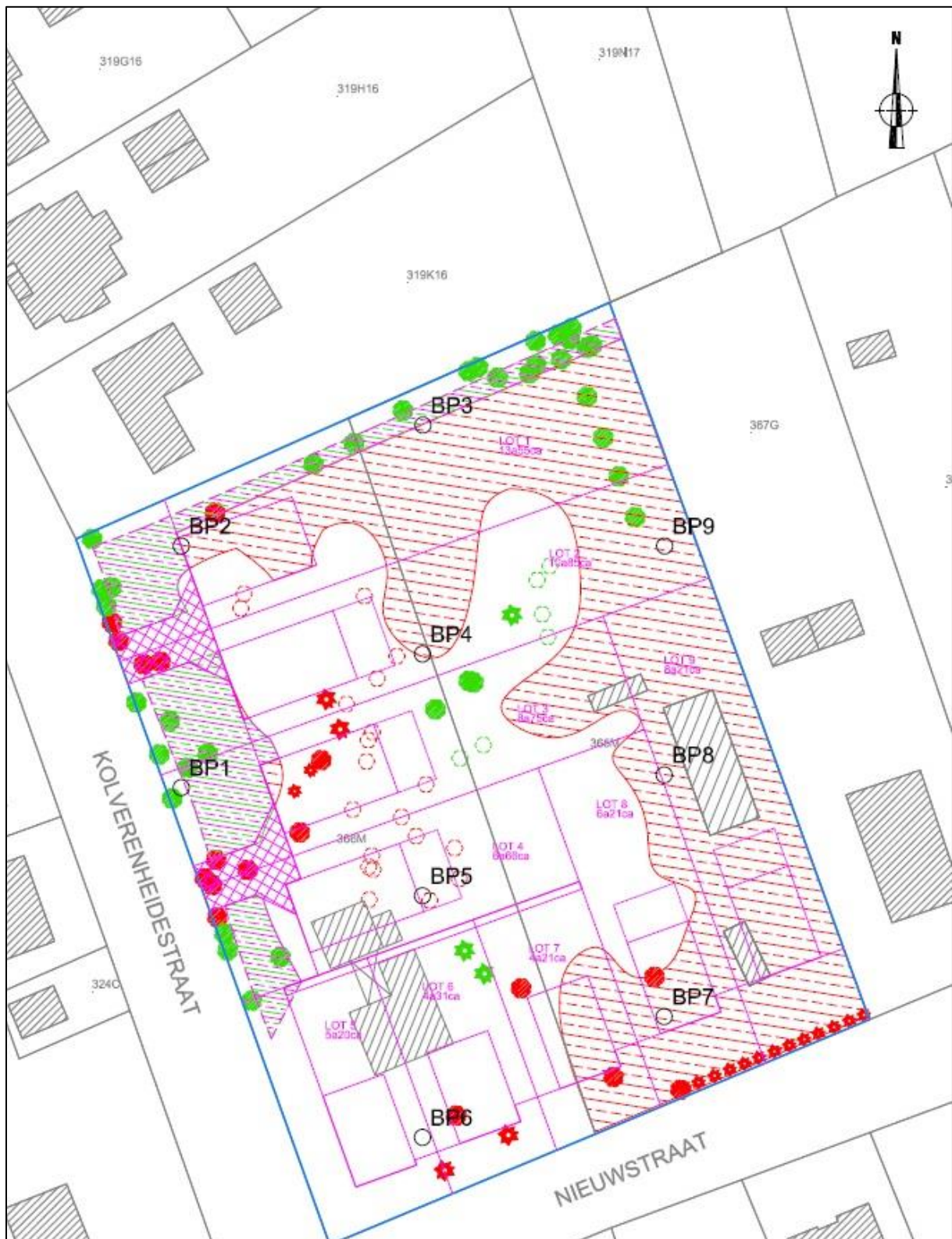
Afb. 28: Plan van de ontworpen toestand met aanduiding van de boorpunten en het onderzoeksterrein (blauw), de te kappen bomen (rood) en de te behouden bomen (groen) (Bron: ARON bvba, digitaal plan, dd. 18/09/2017, aanmaakschaal 1.500, 2017/163).
