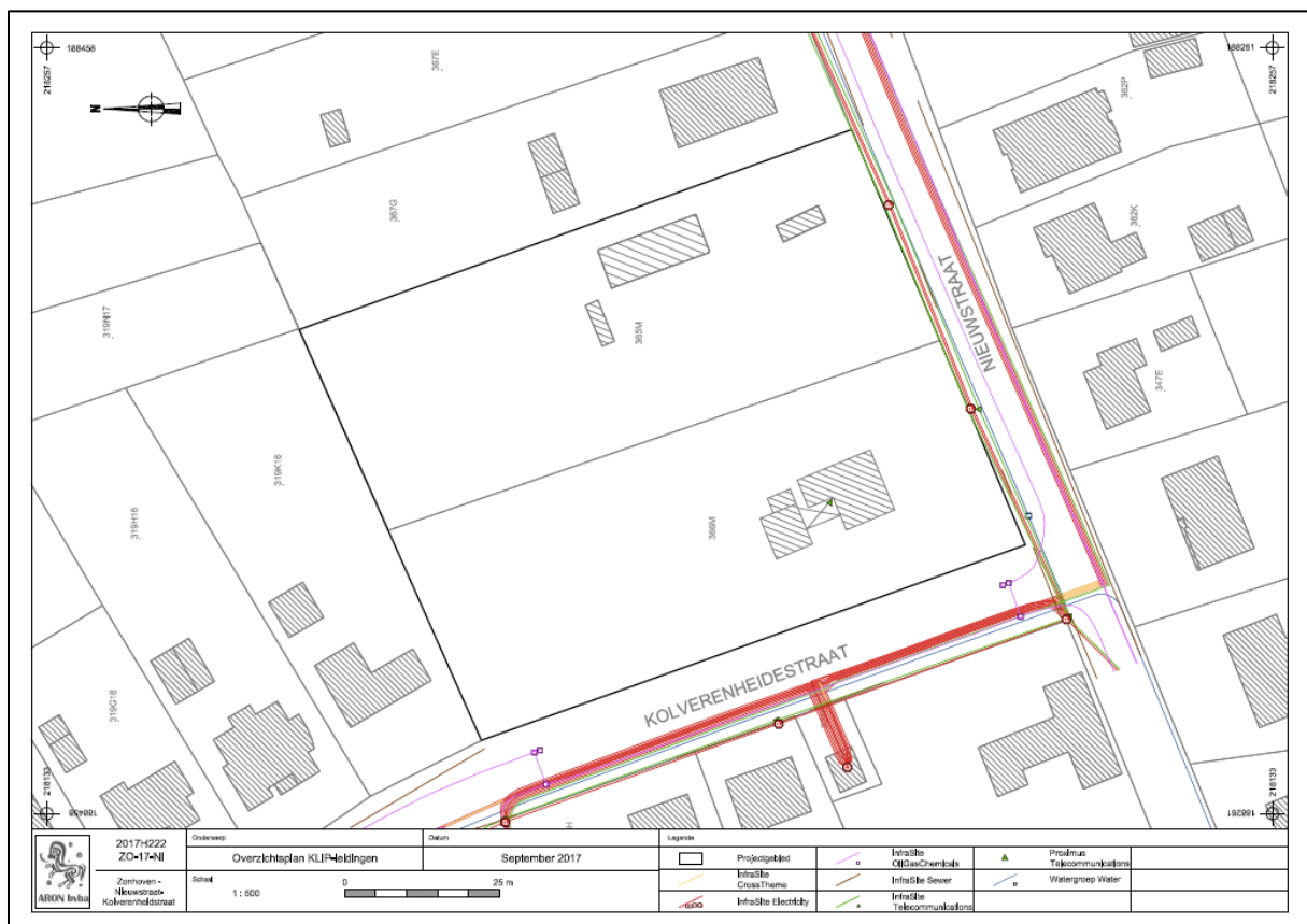
Afb. 26: Overzicht aanwezige nutsleidingen op het onderzoeksterrein
