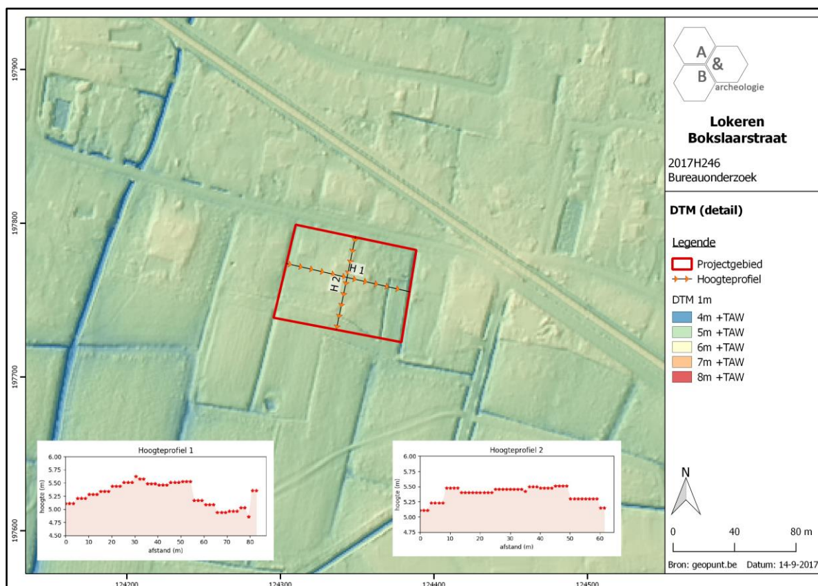
Figuur 13 Detailopname van het Digitaal Hoogtemodel met de twee hoogteprofielen (bron: AGIV).
