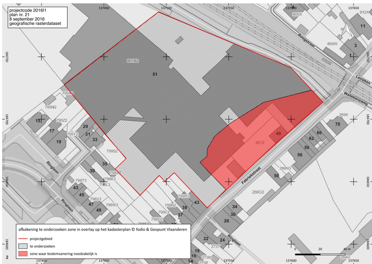
Fig. 25 Afbakening van de zone voor verder onderzoek en de zone waarin de bodem vervuild is en sanering noodzakelijk © Fodio en Geopunt Vlaanderen
