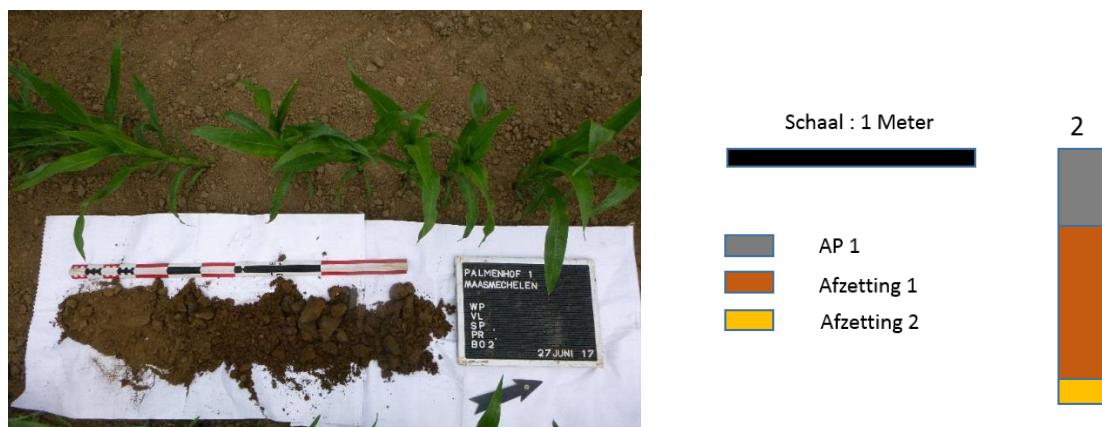
Figuur 47: Boring 2 en tekening Boring 2
