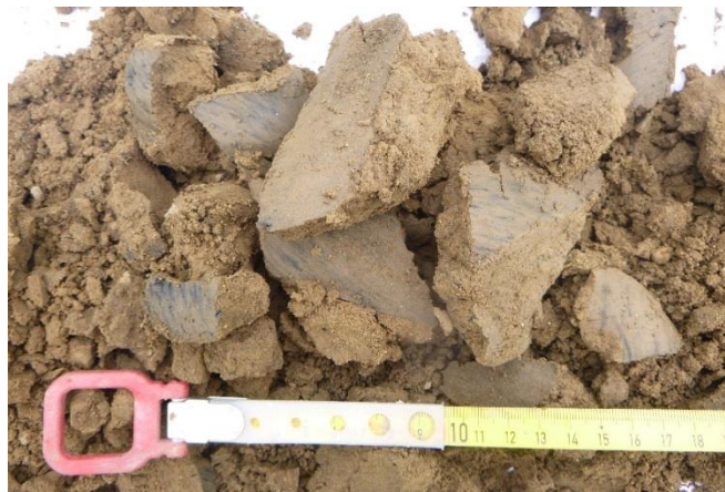
Figuur 48: Detail opname: steenkool sporen in Boring 2
