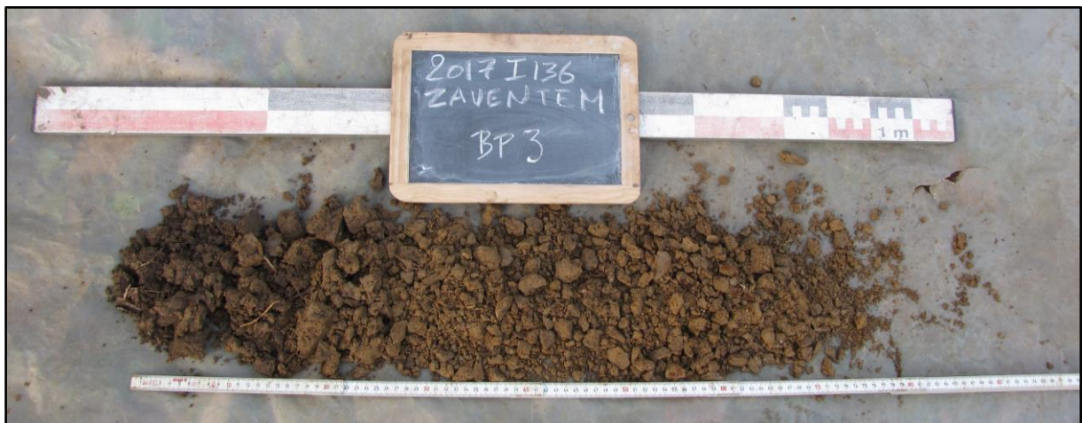
Figuur 29 Zicht op de bodemopbouw ter hoogte van boorpunt 3 waarbij de C-horizont zich meteen onder de teelaarde bevindt.
