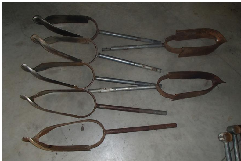
Figuur 3: Voorbeeld Edelmanboor met diameter van 15 cm (©BAAC)
