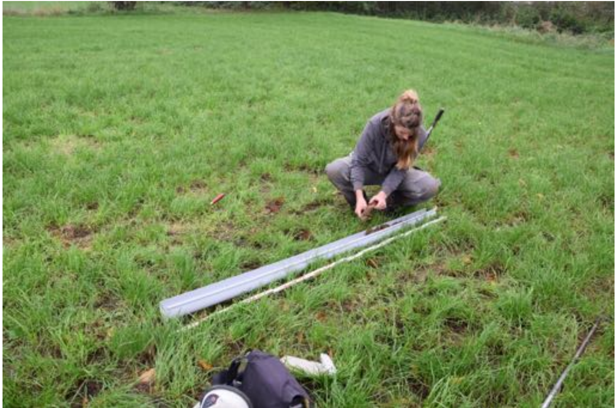
Fig. 1.21: Uitvoering van de boringen gebeurde met een edelmanboor.
