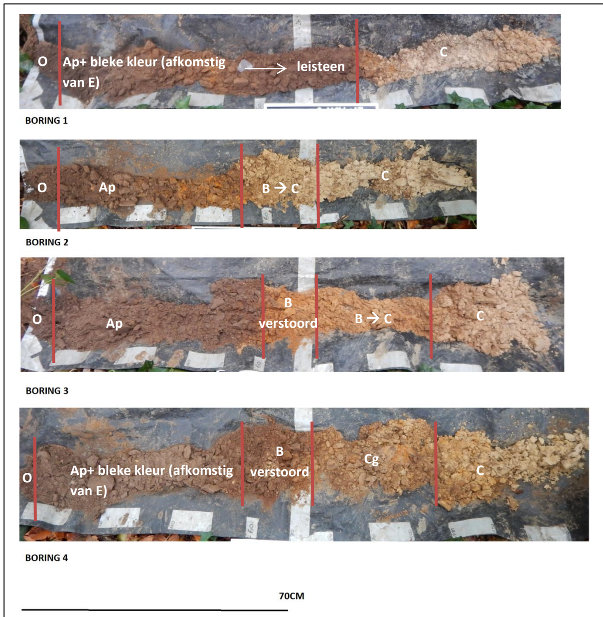
Figuur 25: Foto van boring 1 t.e.m. boring 4 met aanduiding van de verschillende aangetroffen bodemhorizonten
