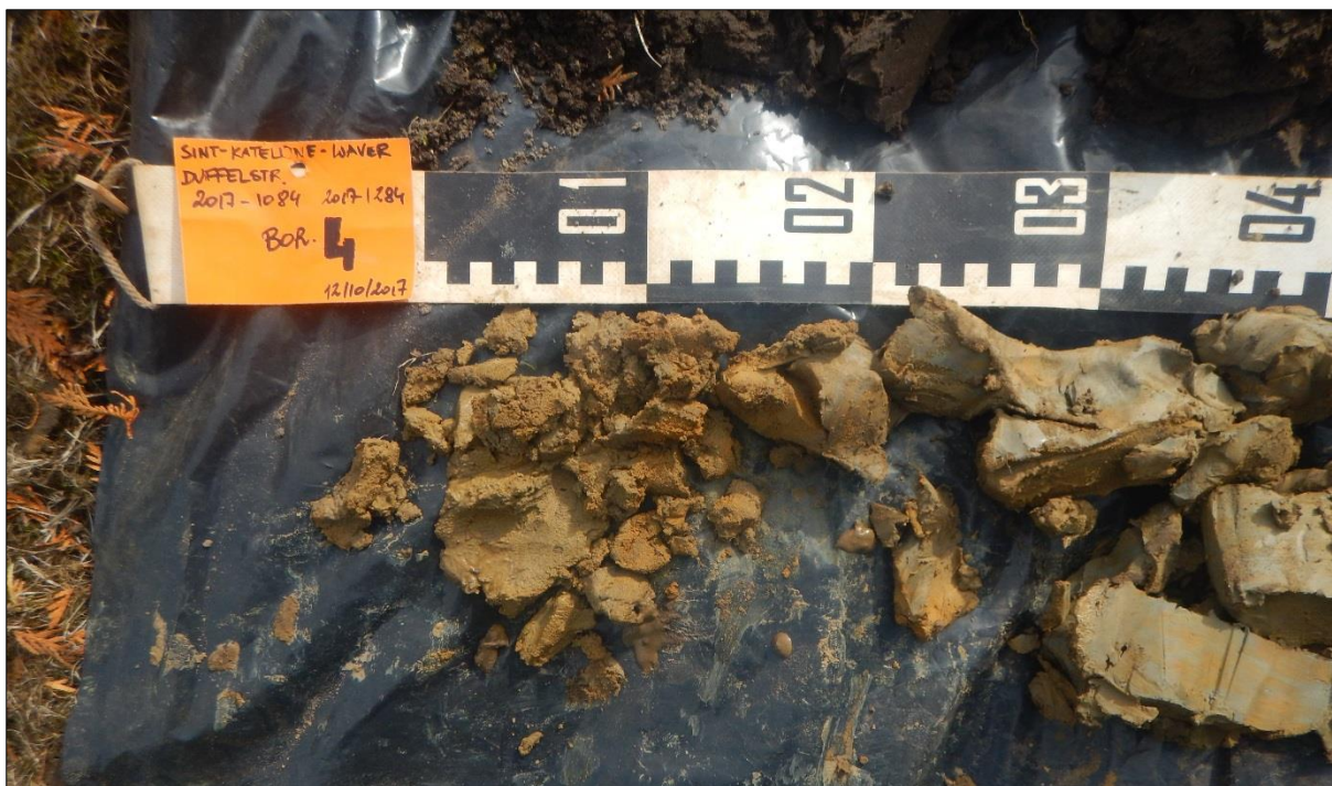
Foto 15: Boring 4, detail overgang kleiig zand naar zandige klei (©BAAC)
