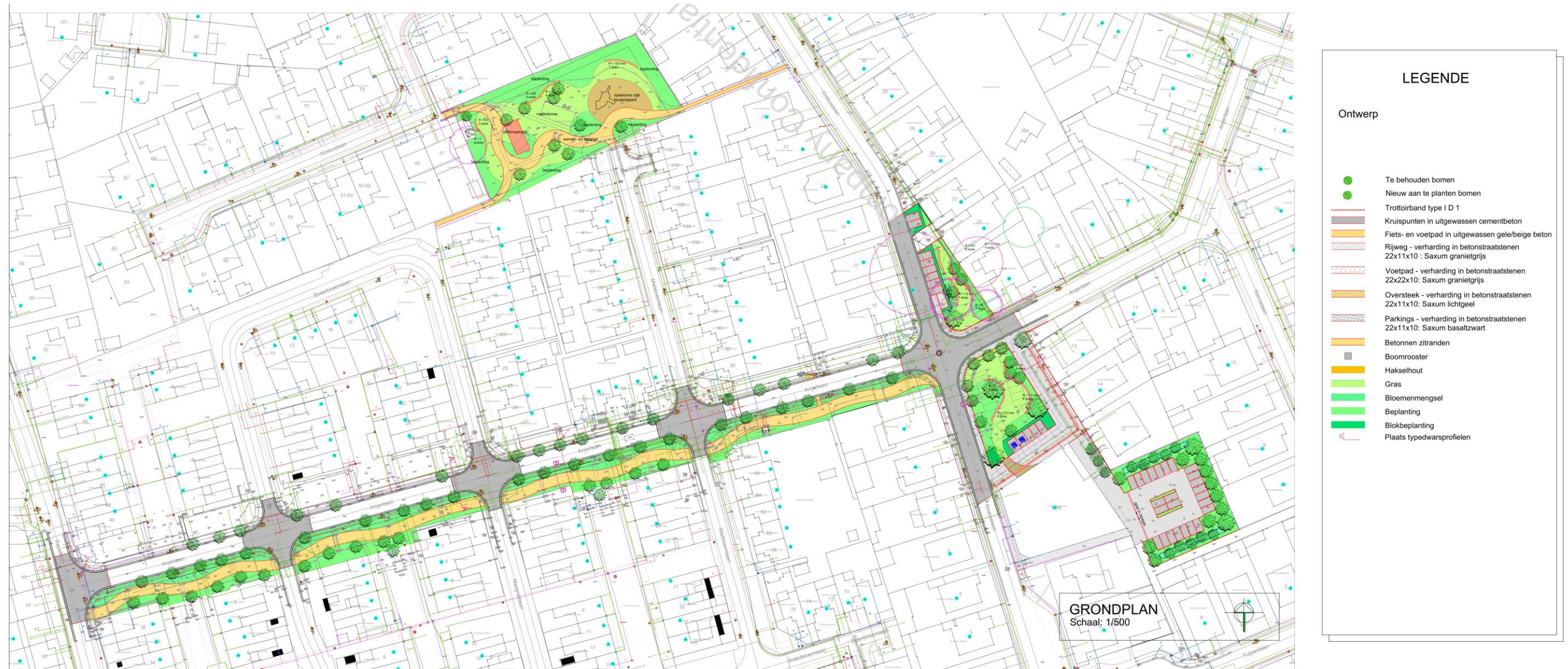
Afb. 7. Grondplan van de nieuwe toestand, met KLIP-gegevens van de bestaande toestand. Zie Afb. 8 voor bijbehorende typedwarsprofielen. (Bron: opdrachtgever)
