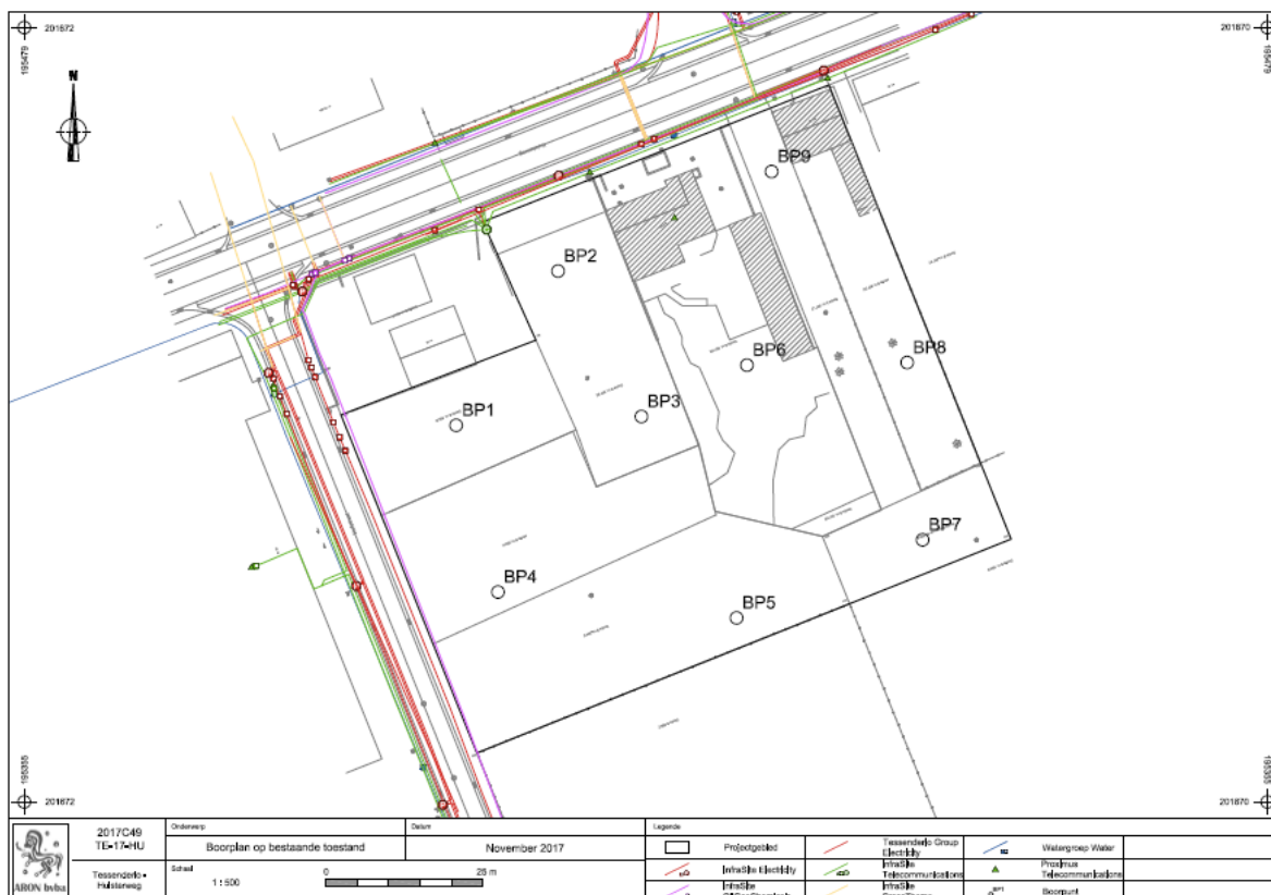
Afb. 28: Inplantingsplan voor een landschappelijk bodemonderzoek op bestaande toestand (BT). (Aron bvba, 21/11/2017; digitaal plan, aanmaatschaal 1:500, 2017C49)
