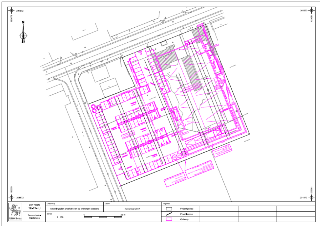
Afb. 30: Sleuvenplan op het ontwerpplan (roze) met aanduiding van het onderzoeksgebied (zwart) (Aron bvba, dd. 21/11/2017, digitaal plan, aanmaatschaal 1.500, 2017C49).
