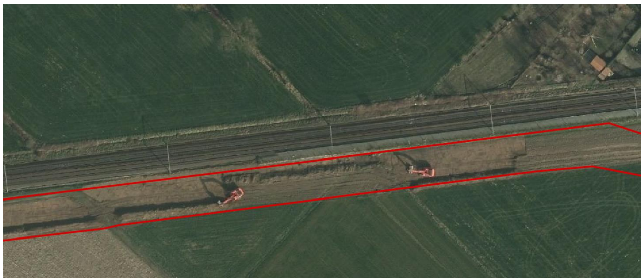
Figuur 8: Foto van het afgraven van de werkzone voor de aanleg van de gasleiding 12
