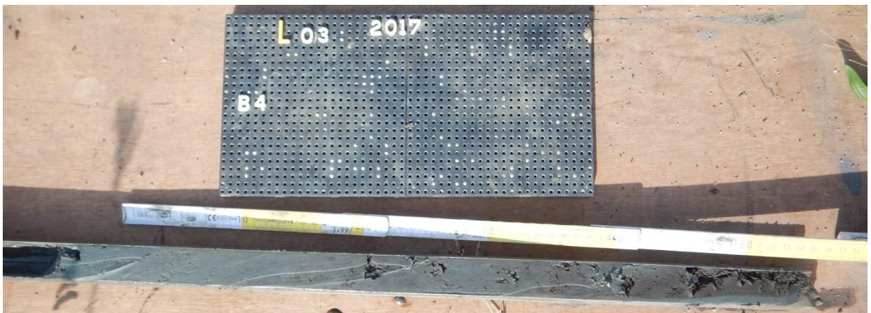
Figuur 56: Boorprofiel ter hoogte van boring 4, van 400 tot 450 cm.
