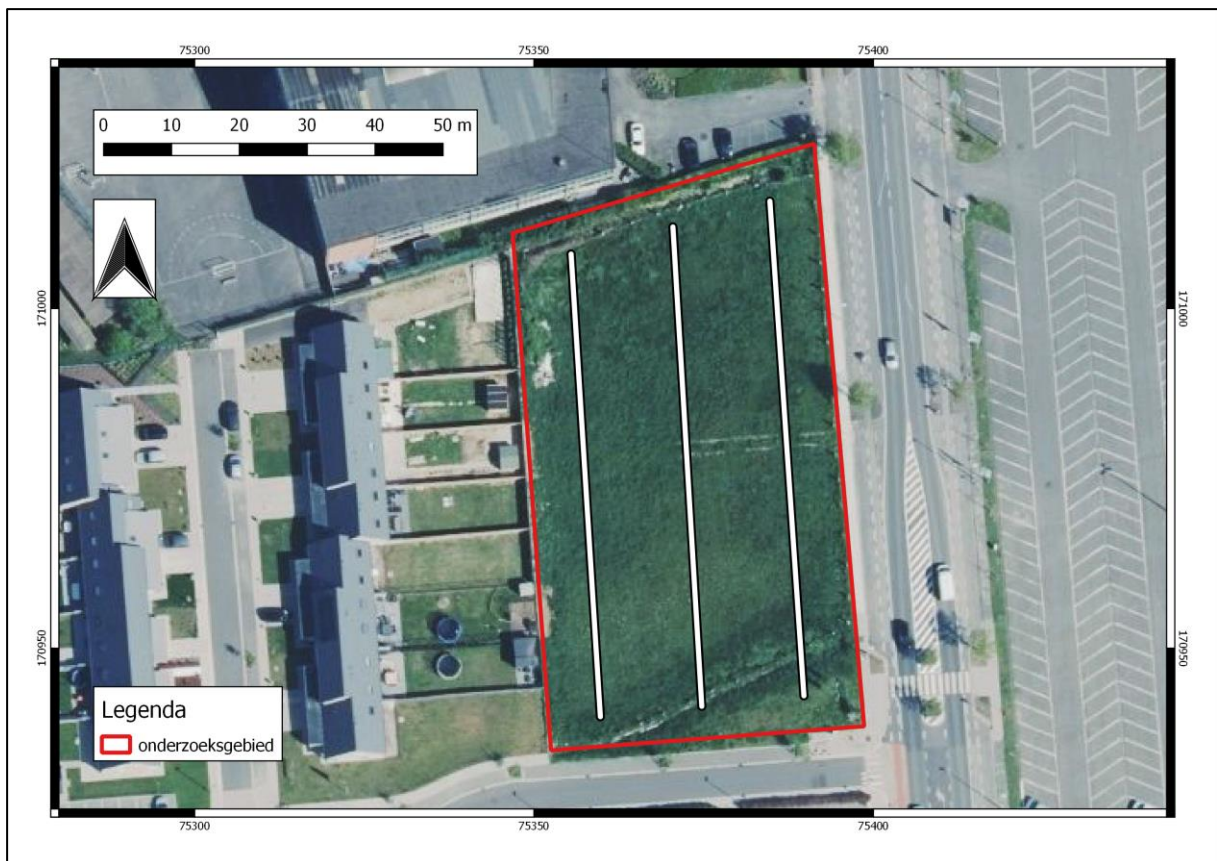
Figuur 34: Voorzien werkputtenplan (Geopunt 2017, Abo nv)
