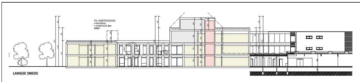
Figuur 5. Doorsnede van het nieuwe Zonnewende I. Schaal 1:250.
